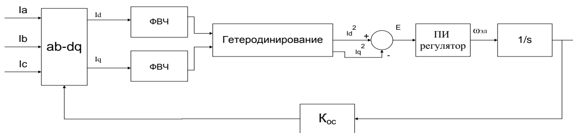
Рис. 1. Математическая модель обработки высокочастотного сигнала для получения углового положения ротора
