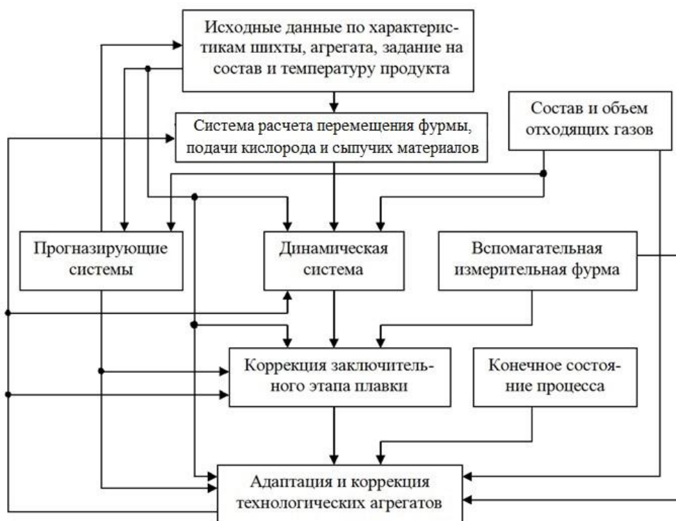
Рис. 1. Структурная схема алгоритмов контроля и управления конвертерным процессом
