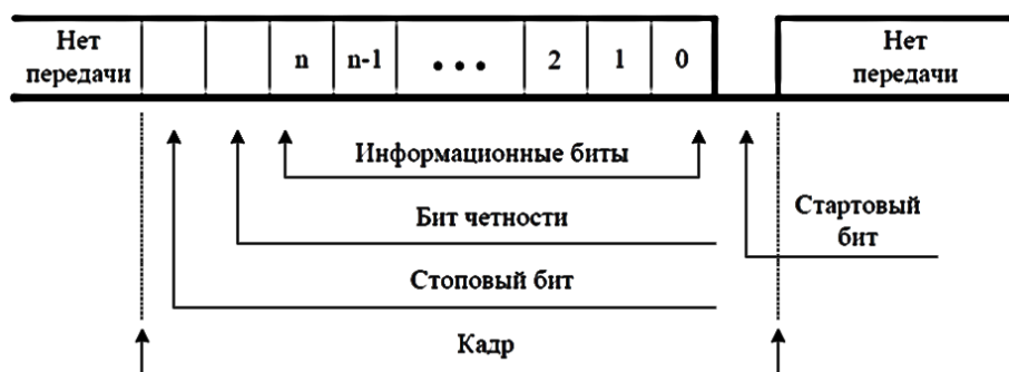
Рис. 1. Формат асинхронной последовательной передачи информационного слова
