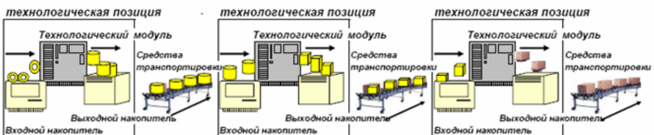
Рис.1. Структура поточной технологической линии
