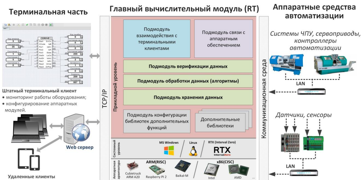
Рис. 3. Архитектура построения основных модулей предлагаемого решения
