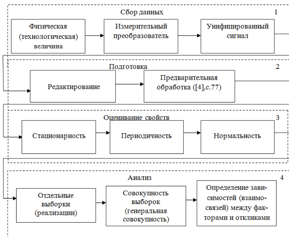
Рис. 2. Обобщенная схема сбора, обработки и анализа данных измерений
