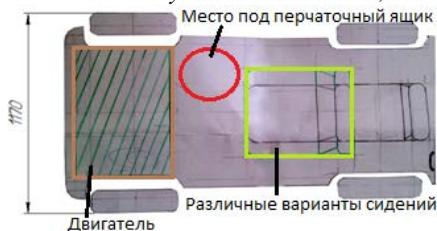
Рис. 10. Схема модульного автомобиля, вид сверху
