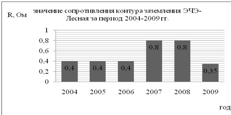
Рис. 3. Значения сопротивления контура заземления ТП Лесная
