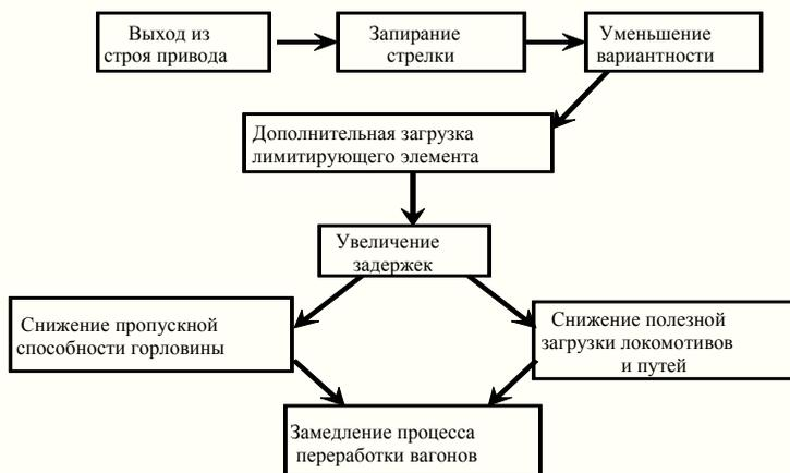
Рис.4. Функциональные последствия выхода из строя электропривода (горловина)
