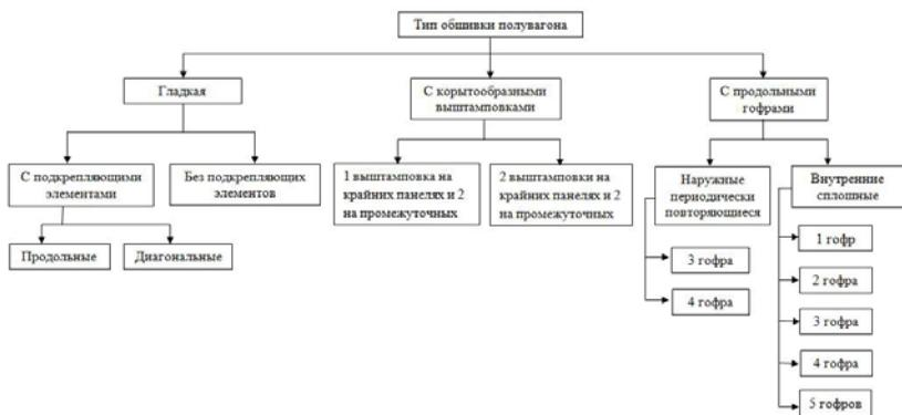
Рис. 4. Классификация обшивки кузовов полувагонов
