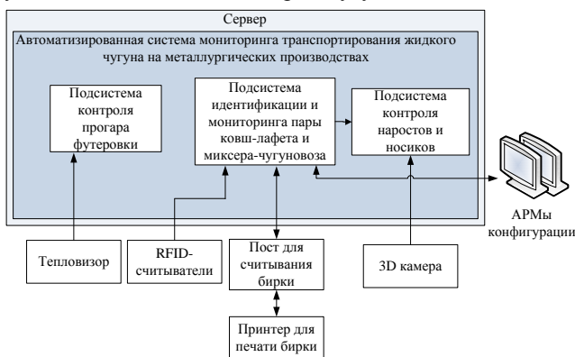
Рис. 1. Архитектура автоматизированной системы мониторинга транспортирования жидкого чугуна на металлургических предприятиях
