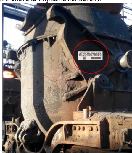
Рис.4. Расположение идентификационной бирки на ковше или миксере-чугуновозе
