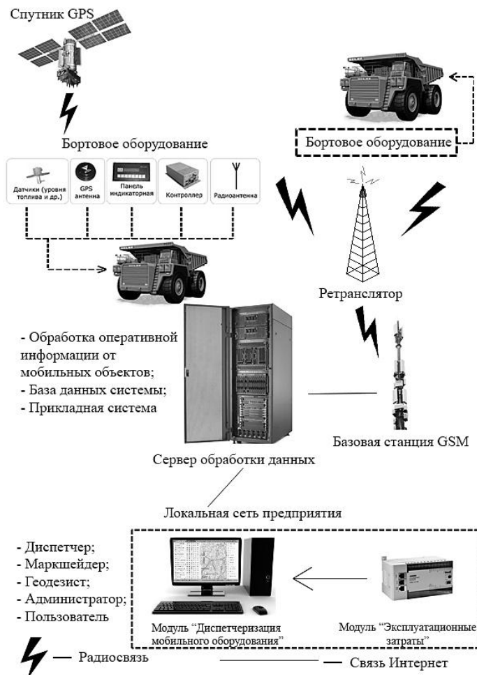
Рис. 2. Структурная схема диспетчеризации системы «КАРЬЕР» с модулем «Эксплуатационные затраты»
