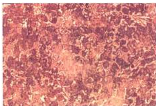
Рис. 1. Микроструктура нового чугуна, залитого в сухую ПГФ
