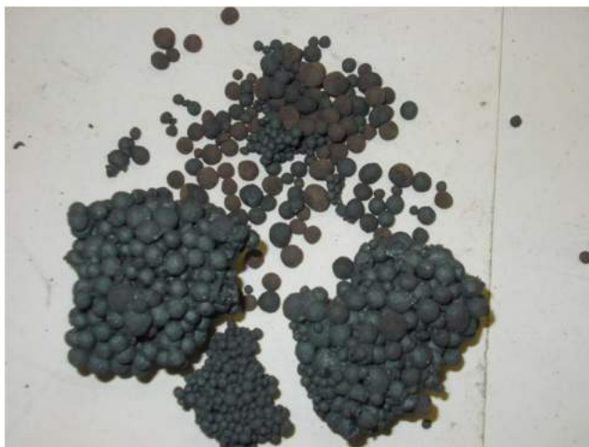
Рис. 5. Гибридный агломерат с оптимальным расходом твердого топлива
