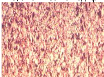
Рис. 3. Микроструктура нового чугуна, залитого в кокиль
