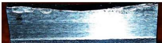
Рис. 2. Характерные сколы на режущей кромке ножей
