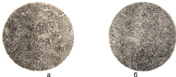
Рис. 2. Микроструктура образцов стали 30ХМЛ, \times 300 : а – после полного отжига при температуре 830^{\circ}\text{C} ; б – после индукционной закалки с последующим низким отпуском
