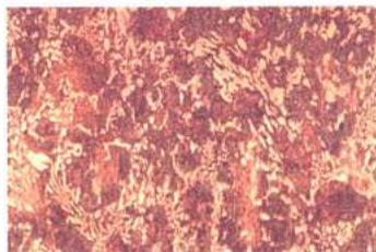
Рис. 2. Микроструктура нового чугуна, залитого в сырую ПГФ
