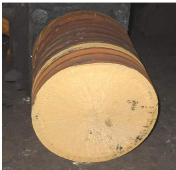
Рис. 1. Хрупкое разрушение сортопрокатного валка
