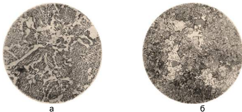
Рис. 1. Микроструктура образцов стали 30ХМЛ, \times 300 :
