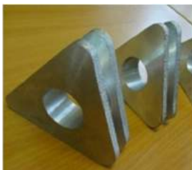
Рис. 6. Отливка после частичной механической обработки
