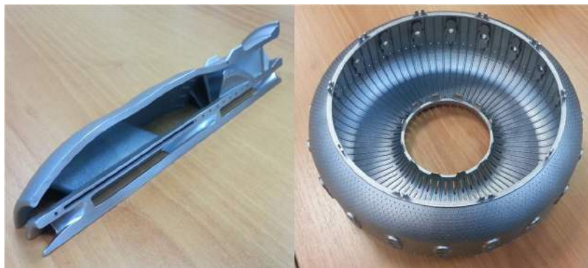
Рис. 4. Детали авиационного двигателя, полученные промышленным методом с помощью селективного лазерного сплавления
