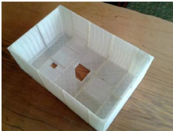
Рис. 7. Стержневой ящик, изготовленный по технологии FDM
