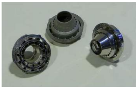
Рис. 2. Пример функциональных деталей, изготовленных с помощью технологии селективного лазерного сплавления
