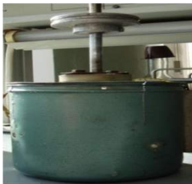
Рис 2. Лабораторная пресс-форма для производства композита
