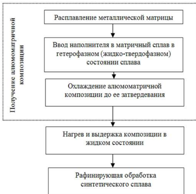
Рис. 1. Технологическая схема получения алюмоматричной композиции и синтетического сплава на ее основе
