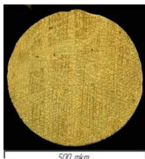
Рис. 1. Микроструктура чугуновой дроби ДЧЛ 08: а – дробь в исходном состоянии; б – дробь после ДЛ
