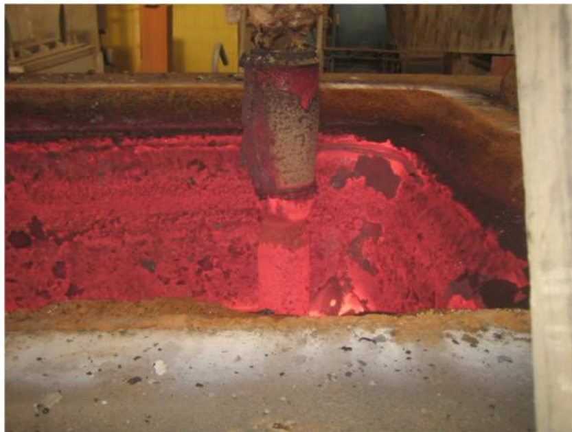
Рис. 3. Критический износ стопора промежуточного ковша МНЛЗ
