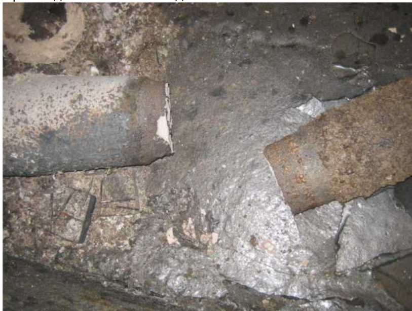
Рис. 2. Износ стопора промежуточного ковша после испытаний шлакообразующих смесей разного состава
