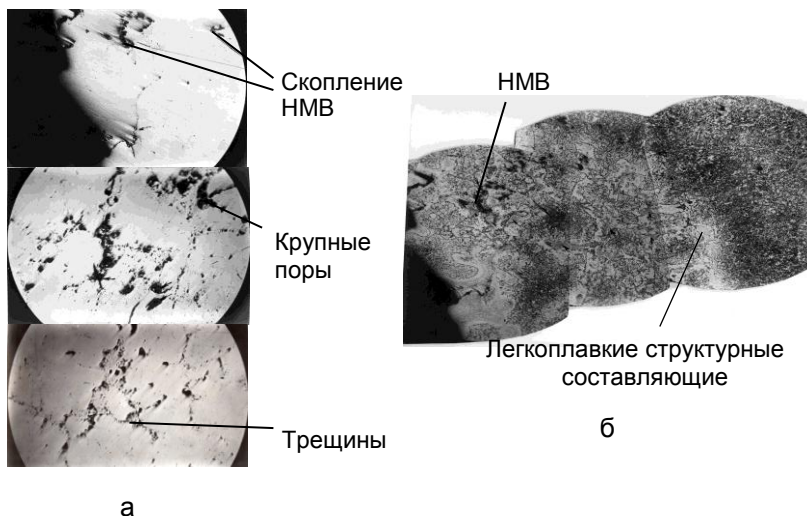
Рис. 2. Нетравленные микрошлифы (а), \times 100 , и микроструктура (б), \times 200 , по трещинам отливки «клапанная коробка» (сталь 35Л, масса 404 кг)
