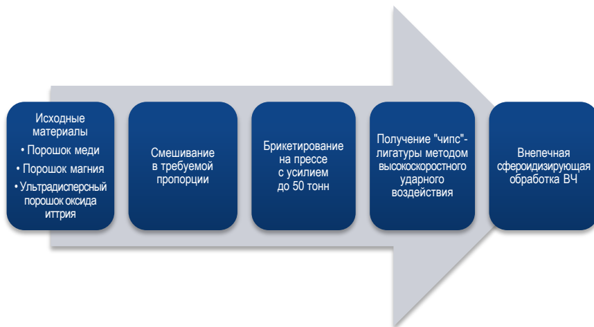
Рис. 2. Технологическая схема получения и применения «чипс»-лигатуры на основе меди для высокопрочного чугуна
