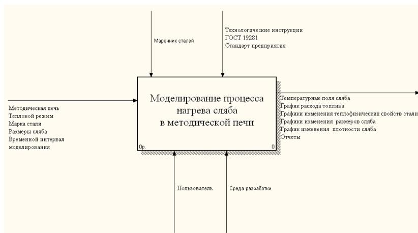
Рисунок 4 - Функциональная схема первого уровня детализации
