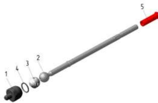
Рис. 2. Общий вид внутреннего рулевого наконечника: 1 – корпус; 2 – палец шаровой; 3 – вкладыш; 4 – кольцо опорное; 5 – колпак защитный
