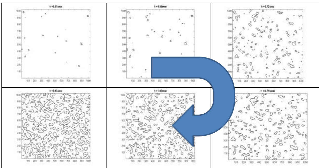
Рис. 4. Сечения на уровнях h = 6,51; 5,58; 3,72; 2,79; 1,86; 0,93 мкм
