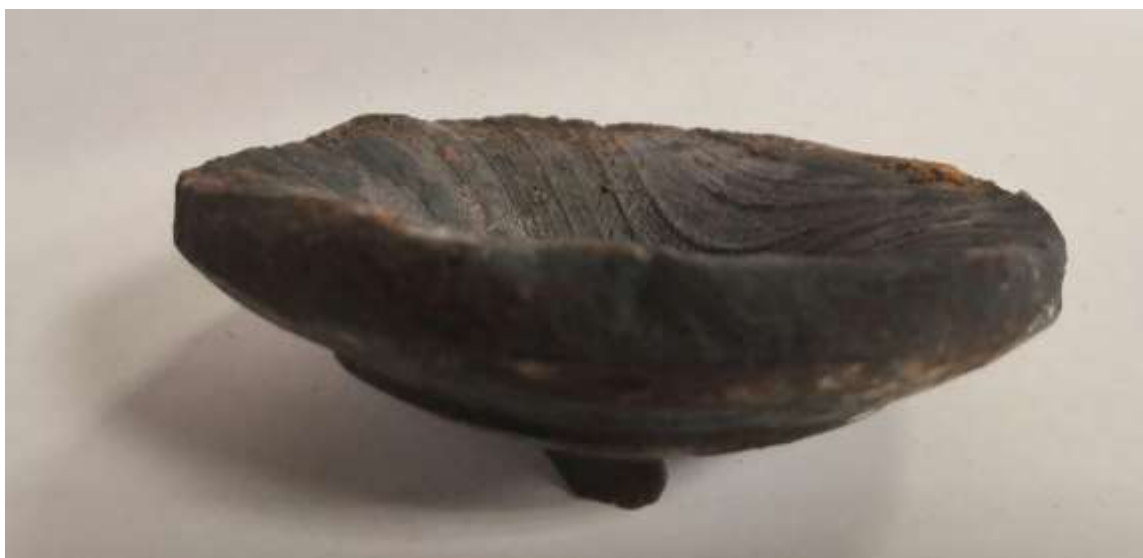
Рис. 3. Половинка, полученная при опытной прокатке
