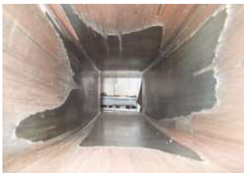
Рис. 1. Характерный вид износа внутренней поверхности гильзы (вид с нижнего торца)
