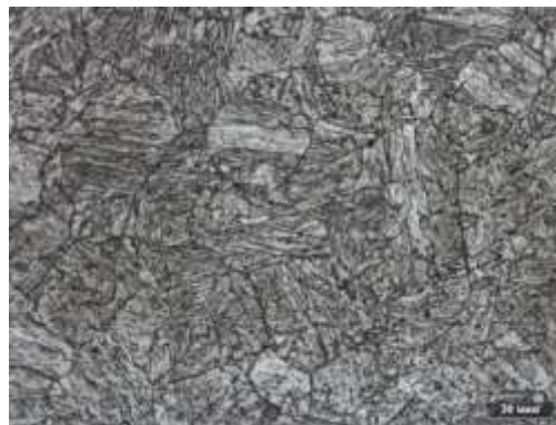
Рис. 2. Микроструктура фасонного проката класса прочности 600 МПа
