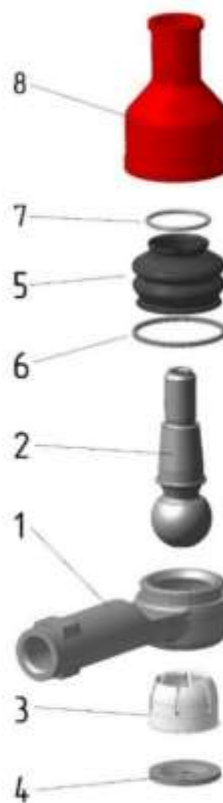
Рис. 1. Общий вид наружного рулевого наконечника: 1 – корпус; 2 – палец шаровой; 3 – вкладыш; 4 – обойма; 5 – чехол защитный; 6 – кольцо пружинное; 7 – кольцо уплотнительное; 8 – колпак защитный
