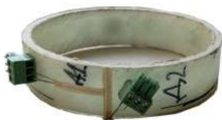
Рис. 5. Образец кольцевых образцов при испытаниях на растяжение
