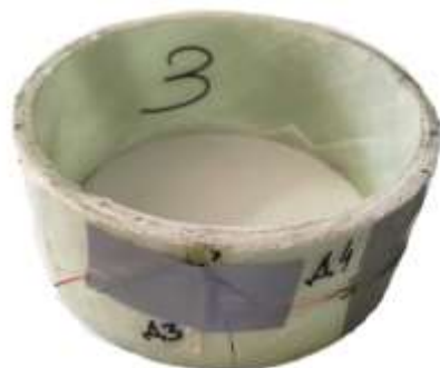
Рис. 6. Образец кольцевых образцов при испытаниях на сжатие
