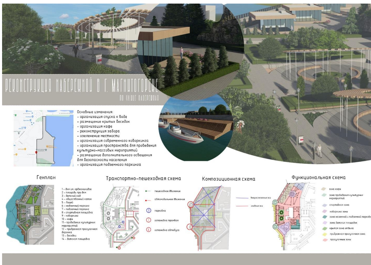
Рис. 1. Предложенная реконструкция набережной около ДК им. С. Орджоникидзе в г. Магнитогорске (автор проекта студент: Богданова Е.В., руководитель: Булатова Е.К.)
