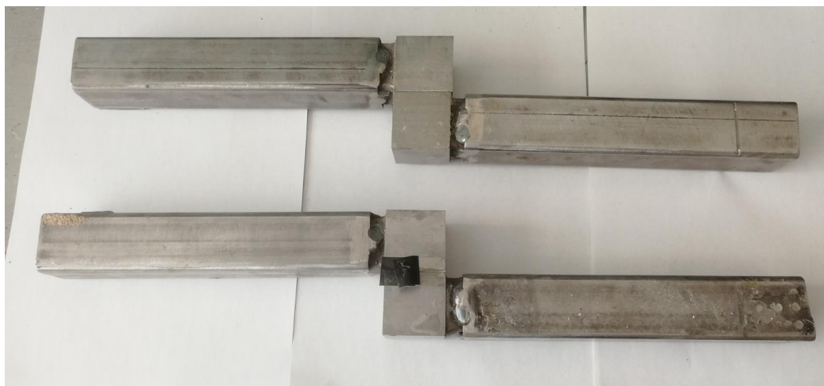
Рис. 4. Стандартные образцы для испытаний на внецентренный отрыв
