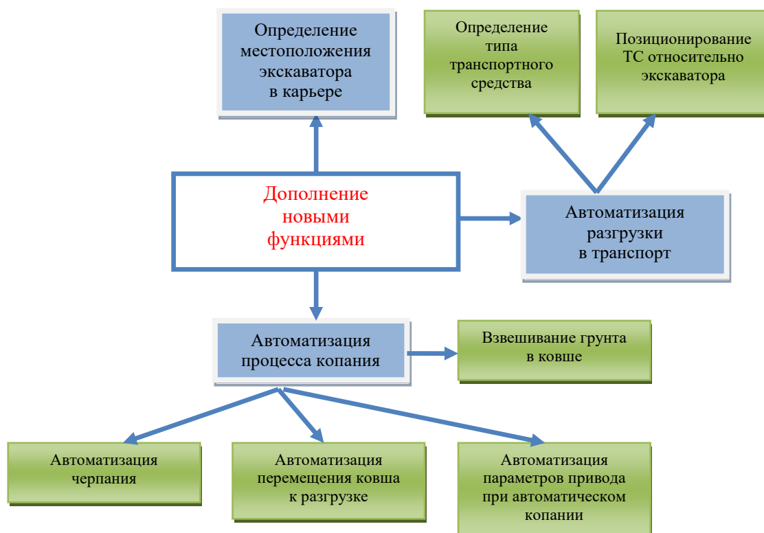
Рис. 2. Автоматизация технологического процесса работы экскаватора
