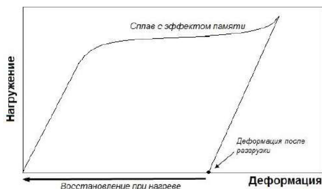
Рис. 1. Диаграмма деформирования материалов с памятью формы
