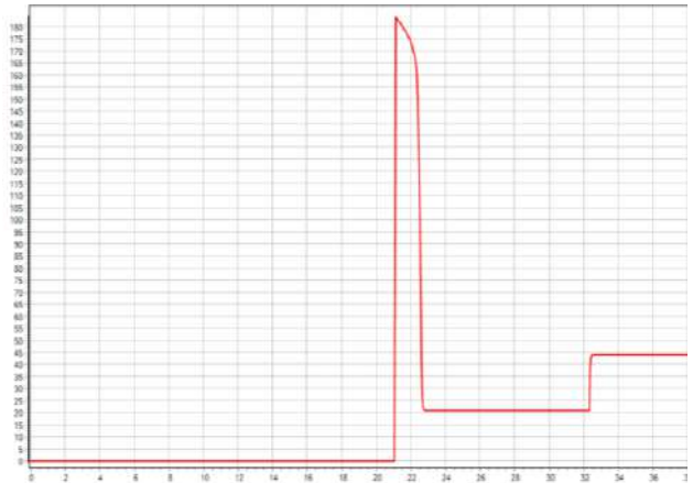
Рис. 4. Изменение тока при пуске и работе под нагрузкой
