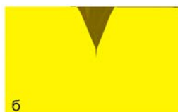
Рис. 8. Форма дефекта (сечение AA): а – до деформации, б – после деформации 15%; в – после суммарной деформации 30%
