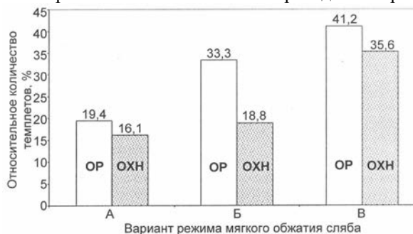
Рис. 3. Результаты оценки количества темплетов со степенью развития дефектов «Осевая рыхлость» (ОП) и «Осевая химическая неоднородность» (ОХН) менее 1,5 балла в слябах толщиной 300 мм из трубной стали, отлитых по различным вариантам мягкого обжатия
