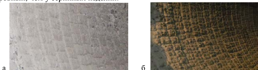
Рис. 2. Вид футеровки с/р ковша после службы в электросталеплавильном цехе: а – экспериментальные изделия; б – серийные изделия
