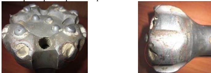
Рис. 1. Отказы коронок: а – срыв породоразрушающих вставок; б – абразивный износ корпуса коронки
