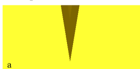
Рис. 4. Форма дефекта (сечение AA) до (а) и после (б) прокатки (суммарная степень деформации 20%)
