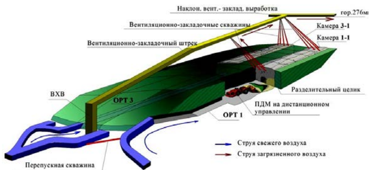
Рис. 3. Камерная система разработки с последующей закладкой
