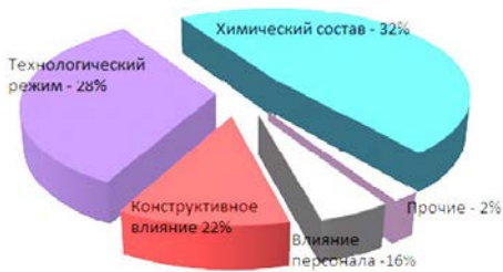
Рис. 2. Причины возникновения дефектов сортовой заготовки
