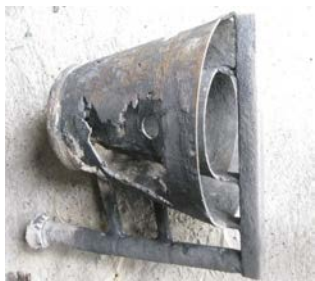
Рис. 3. Отливка с сифонной литниковой системой и добавочными 2 питателями во «внешнюю рубашку»
