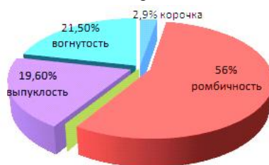
Рис.1. Диаграмма распределения брака по геометрии для марки стали Ст 3сп за 2009–2011 гг.
