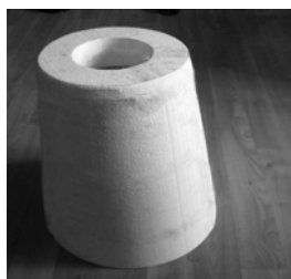
Рис. 4. Готовая пенополистироловая модель доменной фурмы
