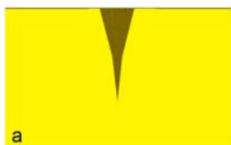
Рис. 8. Форма дефекта (сечение AA): а – до деформации, б – после деформации 15%; в – после суммарной деформации 30%
