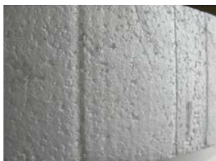
Рис. 3. Брак на модели, вырезанной «холодной» струной
