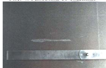
Рис.5. Искусственно нанесенный дефект «сетка»
