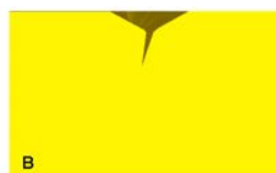
Рис. 8. Форма дефекта (сечение AA): а – до деформации, б – после деформации 15%; в – после суммарной деформации 30%
