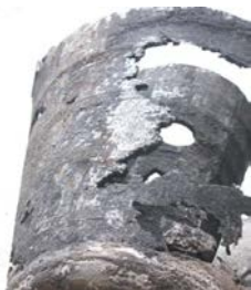
Рис. 1. Отливка, полученная в результате заливки через рыло сифонной литниковой системой
