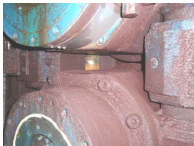
Рис. 3. Расположение роликов валковой арматуры при замере их температуры во время прокатки
