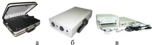
Рис. 6. Устройства гарантированного стирания информации: а – раскат (Кейс); б – «Магма-4»; в – Стек-НС2.1
