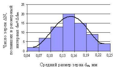
Рис. 4. Гистограмма и соответствующая ей функция распределения Гаусса числа зерен, попавших в интервал от d_m до d_m + \Delta d_m , для низколегированного медного сплава с содержанием 1,1 мас. % Fe
