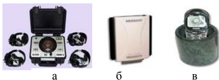
Рис. 3. Устройства защиты от утечки акустической информации: а – зашумляющая акустическая система ХАОС; б – виброакустический генератор шума VNG; в – акустический сейф для мобильных телефонов Ладья
