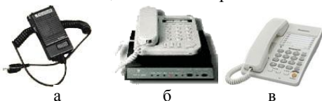
Рис. 2. Скремблеры: а – скремблер для радиостанций; б – OPEX A; в – референт, устройство для защиты телефонных переговоров
