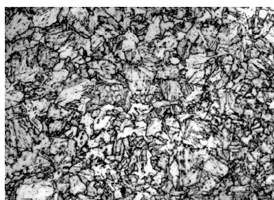
Рис. 3. Структура низколегированной трубной стали после закалки от 900°С и отпуска при различных температурах: а – 600°С; б – 700°С
