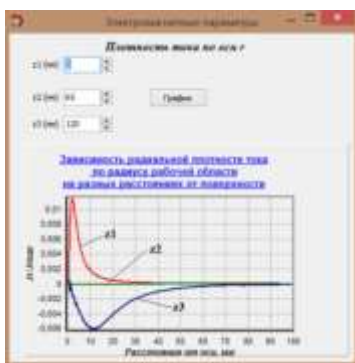
Рис. 2. Зависимость радиальной (а) и осевой (б) плотности тока по радиусу рабочей области лабораторной установки на разных расстояниях от поверхности
