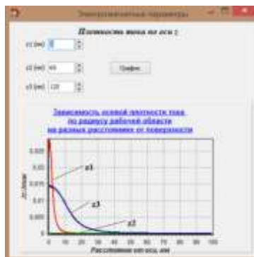
Рис. 2. Зависимость радиальной (а) и осевой (б) плотности тока по радиусу рабочей области лабораторной установки на разных расстояниях от поверхности
