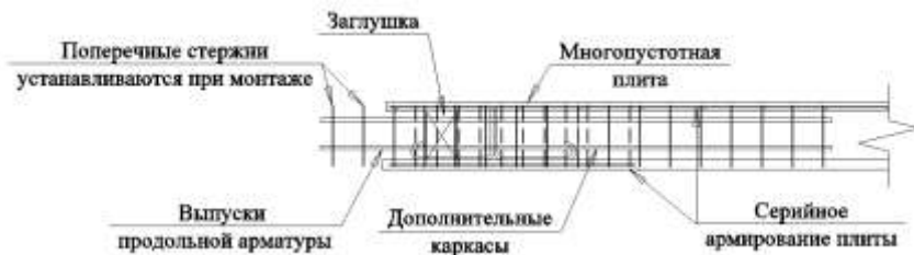
Рис. 1. Многопустотная плита с установкой дополнительных каркасов
