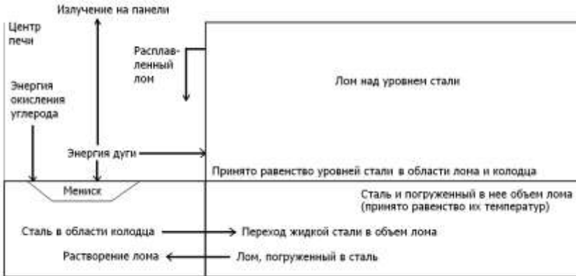
Рис. 2. Общая схема моделируемых процессов при расплавлении шихтовых материалов в ДСП
