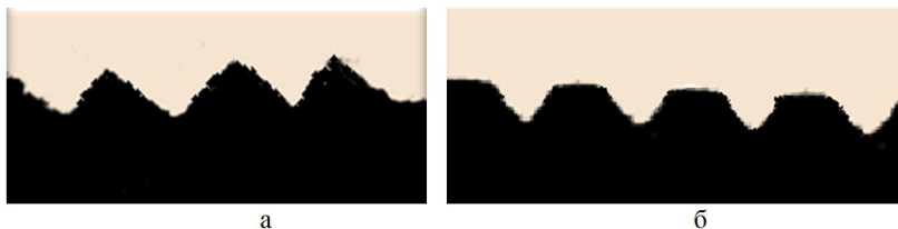
Рис. 2. Профиль неровностей (увеличение \times 400 ): а – исходный профиль; б – после обработки ПВД
