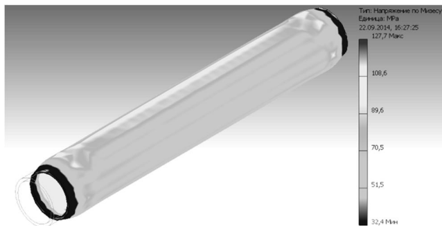
Рис. 2. Напряженное состояние гильзы гидроцилиндра в исходной конструкции
