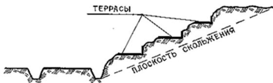
Рис. 4. Схема устройства террас для разгрузки оползневых склонов
