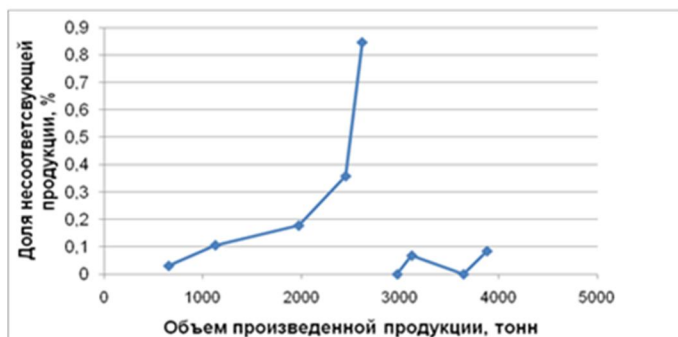
Рис. 2. Зависимость доли несоответствующей продукции от продолжительности кампании валков профилигибочного стана 1-5×300-1650 (точка разрыва – остановка в связи с калибровкой валков)
