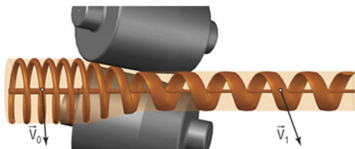
Рис. 1. Схема течения внешнего слоя заготовки ( V_{0(1)} – скорости движения металла до и после очага деформации)
