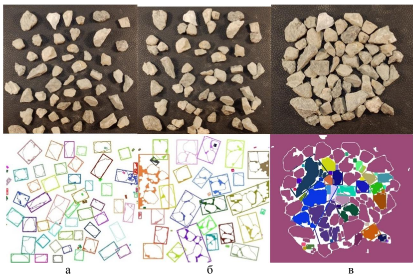
Рис. 2. Определение контуров на изображении зерен, расположенных: а – по отдельности; б – группами; в – слоем
