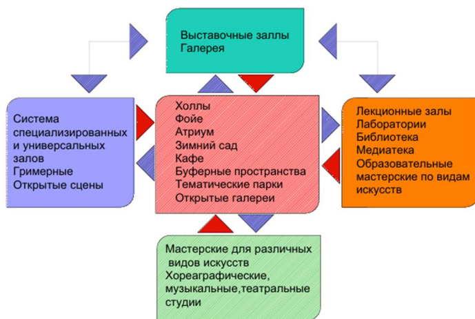
Рис. 2. Типовая общая функциональная схема комплексного Центра творчества
