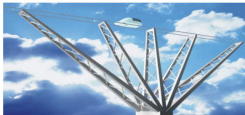
Рис. 3. Высокая промежуточная поддерживающая опора, совмещенная с вертикальной кривой большого радиуса
