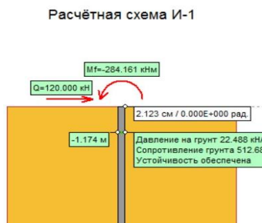
Рис. 4. Схема нагрузок на сваю
