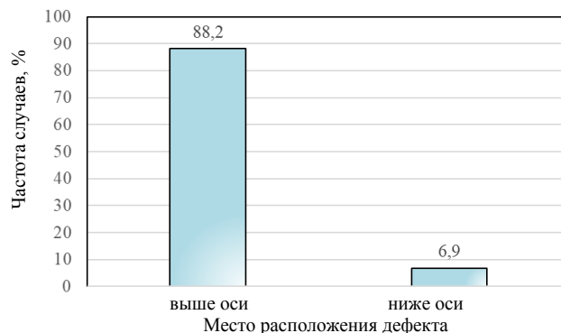
Рис. 5. Данные о частоте образования трещин, перпендикулярных широким граням, в приосевой зоне заготовки
