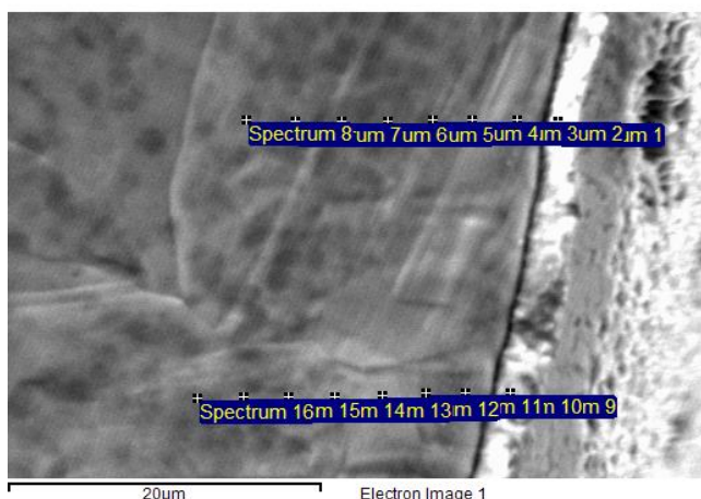
Рис. 2. Микрофотография МРСА на образце после ионного травления
