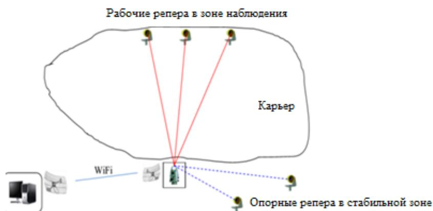
Автоматизированная станция маркшейдерского (геомеханического) мониторинга
