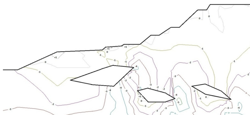
Рис.9. Изолинии главных нормальных напряжений \sigma_2 при открытом очистном пространстве
