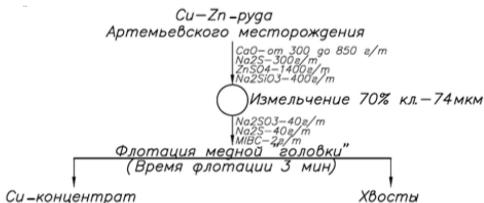
Рис. 1. Технологическая схема проведения серии флотационных опытов
