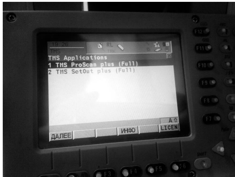
Рис. 1. Электронный роботизированный тахеометр Leica TCRA1202+ с установленными на нём программным обеспечением TMS Applications: TMS ProScan plus, TMS SetOut plus
