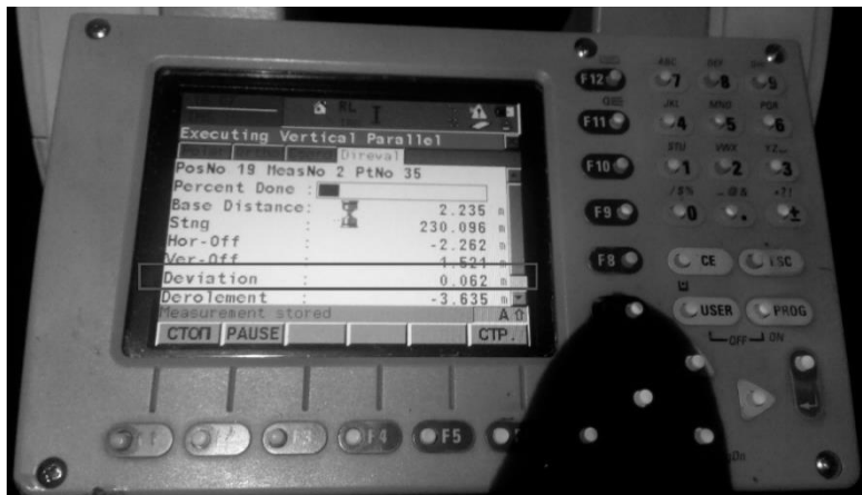
Рис. 5. Определение отклонения выработки от проекта при нахождении непосредственно в забое
