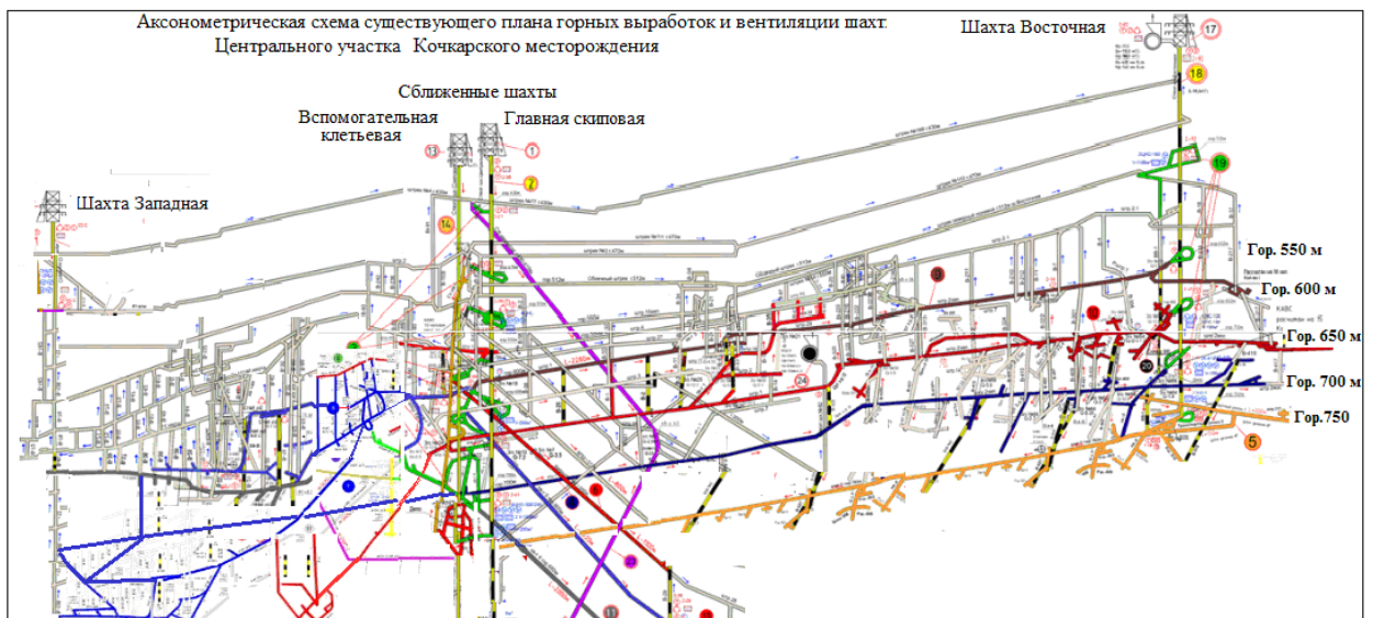
Рисунок 4.2 - Аксонометрическая схема горных выработок шахты «Центральная» Кочкарского месторождения: глубина ствола шахты «Центральная» H_{ст}=1000 м; высота этажа блока H_{эт}=50 м; высота промежуточного горизонта h_{п.у}=10 м
