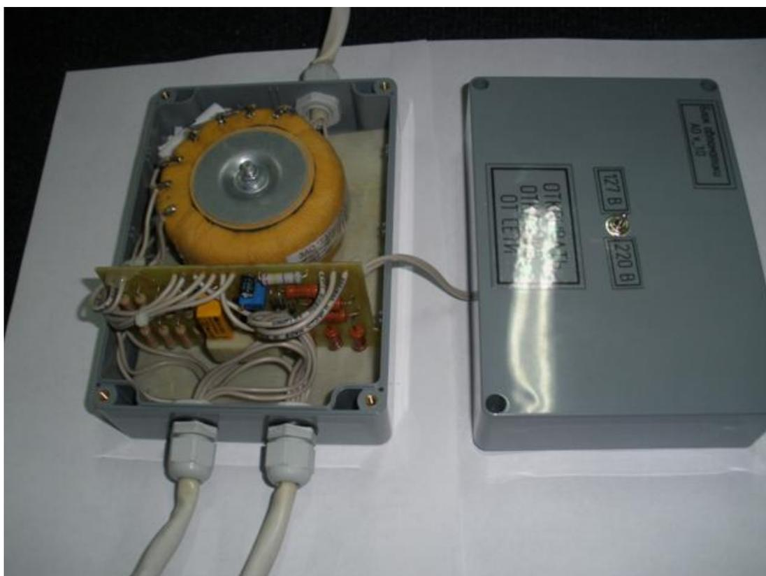
Электронный блок контроля изоляции горно-металлургического
