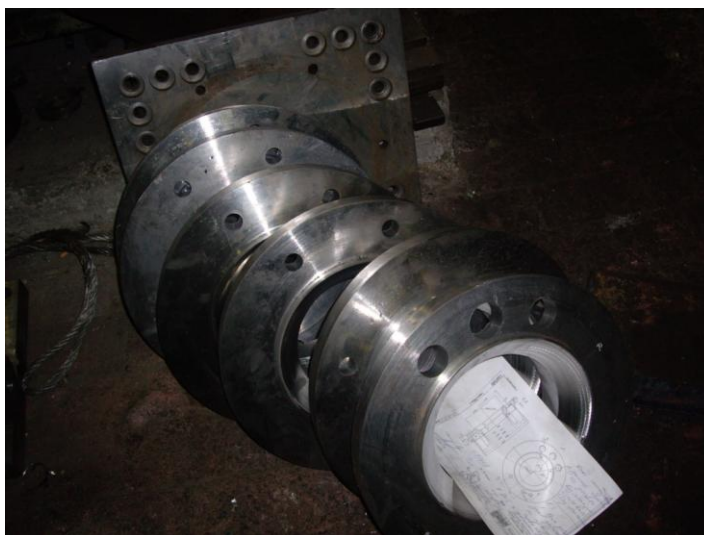
Опытная партия фланцев из патентованной марки стали для фурм доменной печи (ООО «Литейно-металлургические технологии»)
