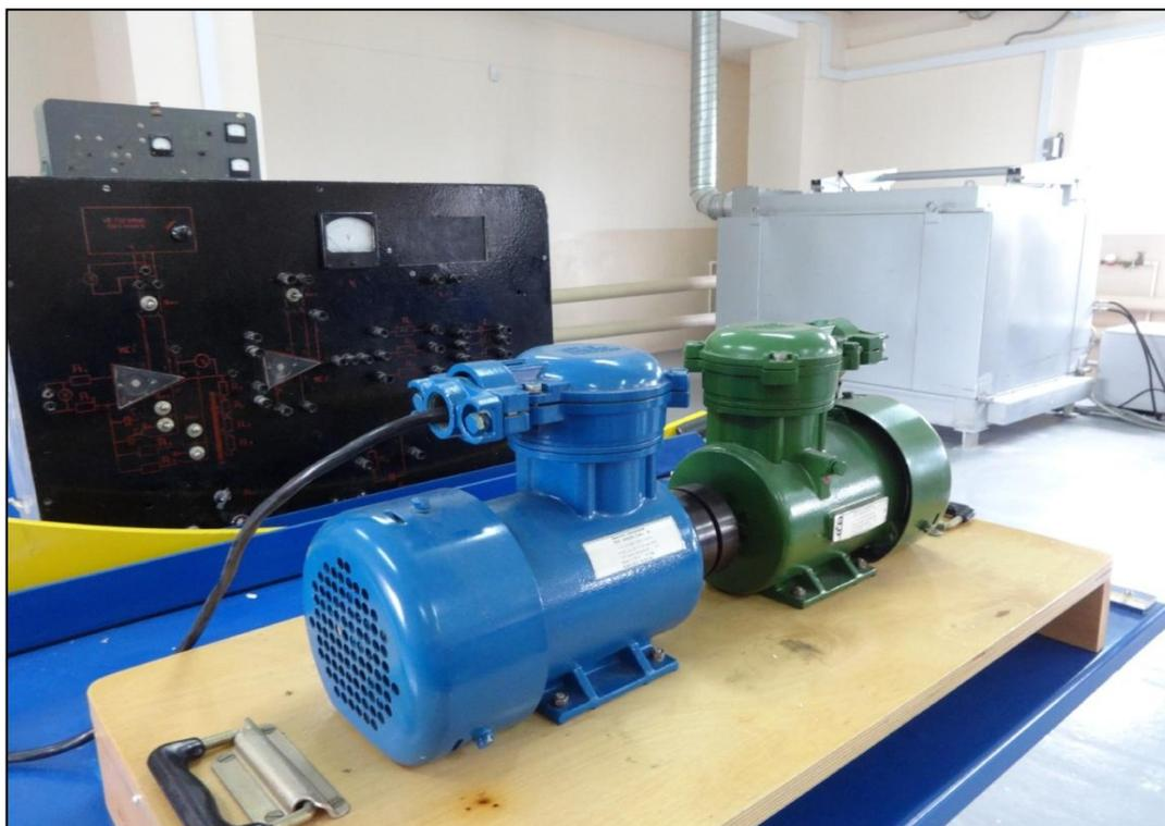
Взрывозащищенные асинхронные двигатели тип АИМЛ-71
