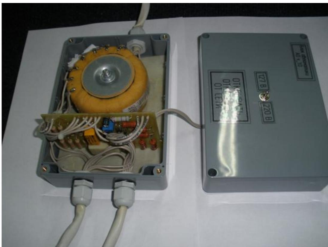
Электронный блок контроля изоляции горно-металлургического
