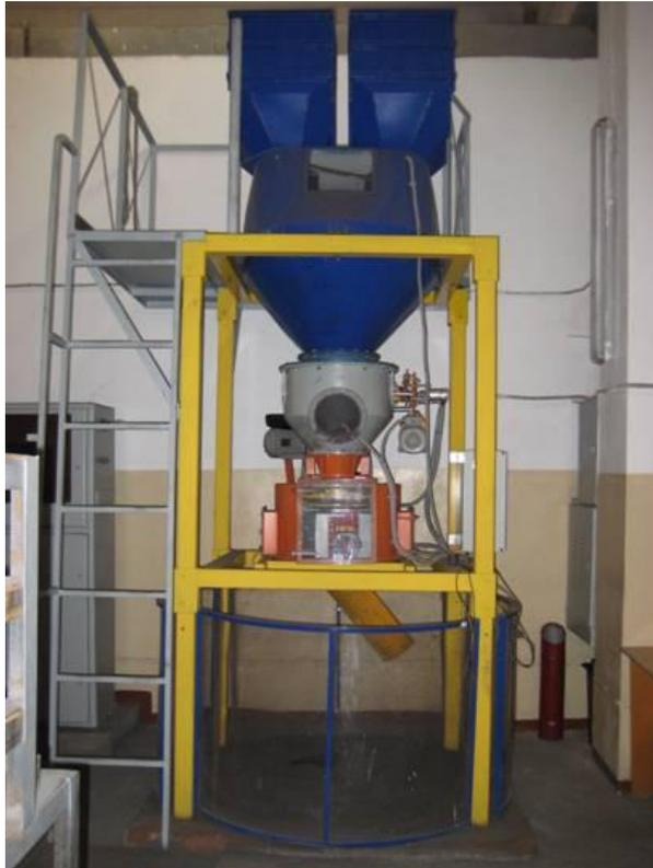
Рисунок 2.1 – Физическая модель однотокового компактного загрузочного устройства лоткового типа
