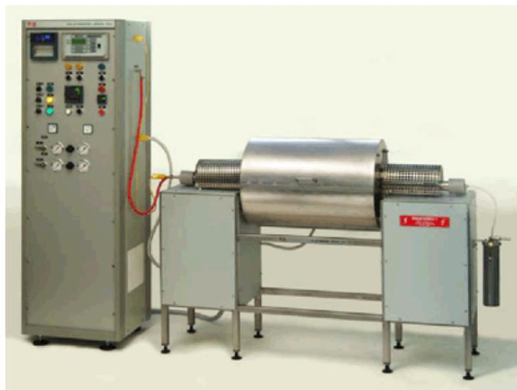
Рисунок 5.5 – Шкаф управления и горизонтальная печь для определения горячей прочности железорудных материалов по ISO 13930:2007
