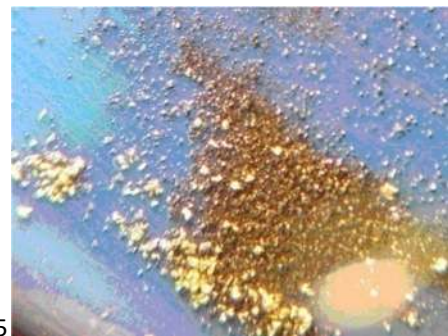
Рисунок 4.2 – Фотография рудного золота класса -0,45\text{ мм}, +0,03\text{ мм} из валунчатых руд
