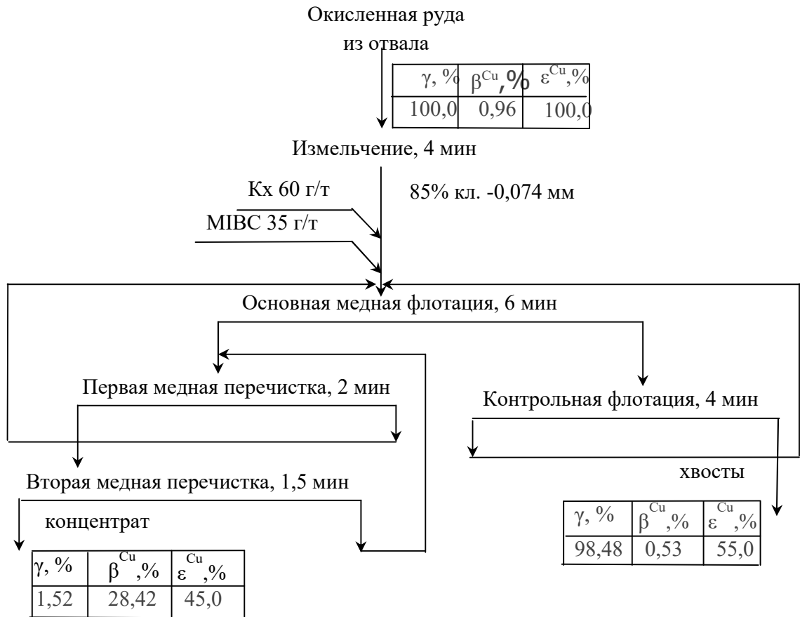
Рисунок 3.8 – Схема и результаты флотационного обогащения в замкнутом цикле
