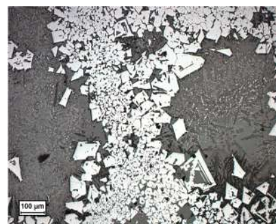
Рисунок 6.21 – Скелетные кристаллы магнетита. Отраженный свет, николи параллельны
