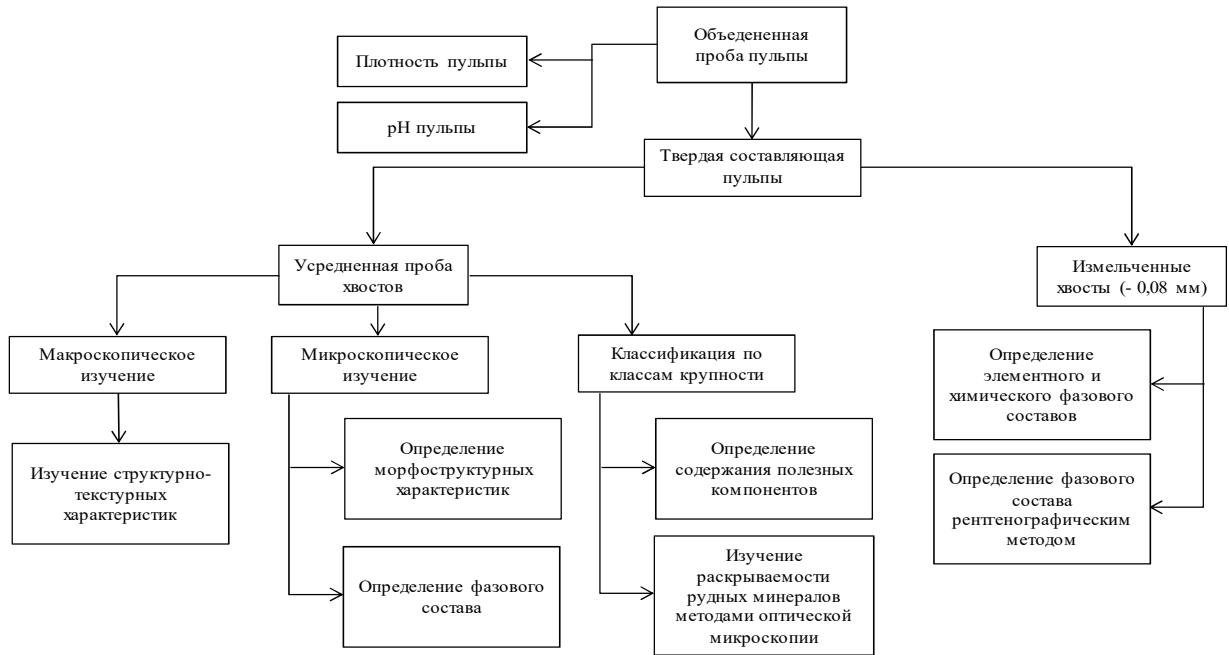
Рисунок 2.3 – Схема проведения минералого-аналитических исследований текущих хвостов обогащения
