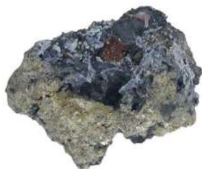
Рисунок 6.10 – Внешний вид шлака фракции 0-20 мм
