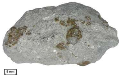
Рисунок 6.5 – Внешний вид шлака фракции 0-65 мм
