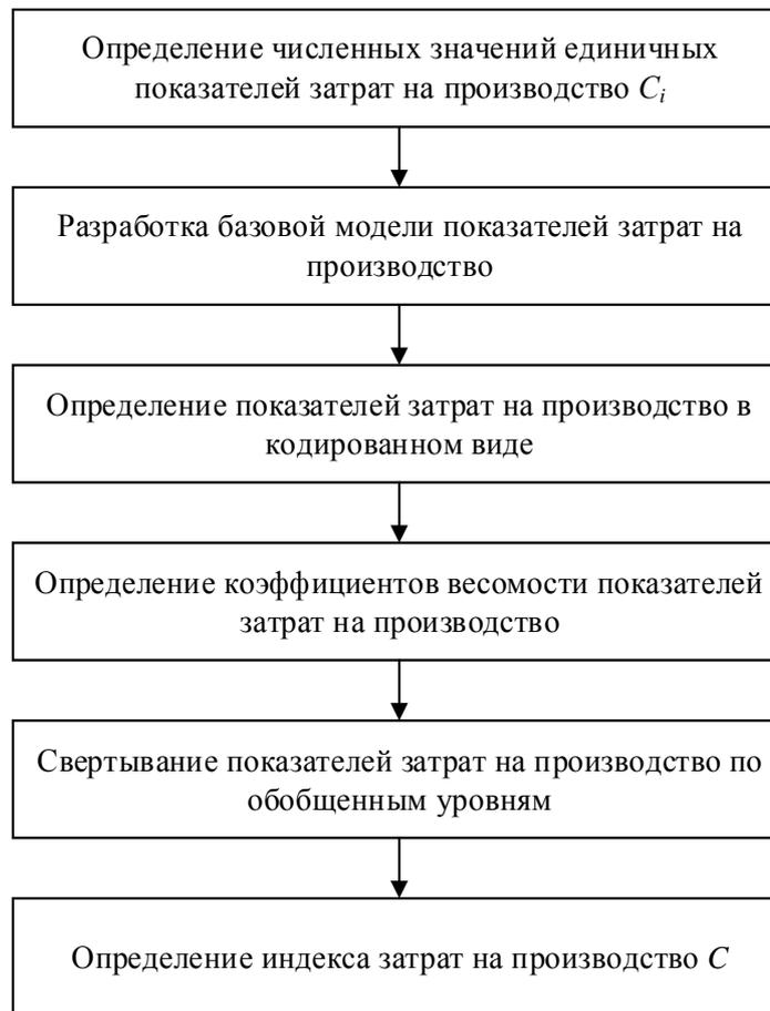
Рисунок 2.4 – Блок-схема для определения индекса затрат на производство
