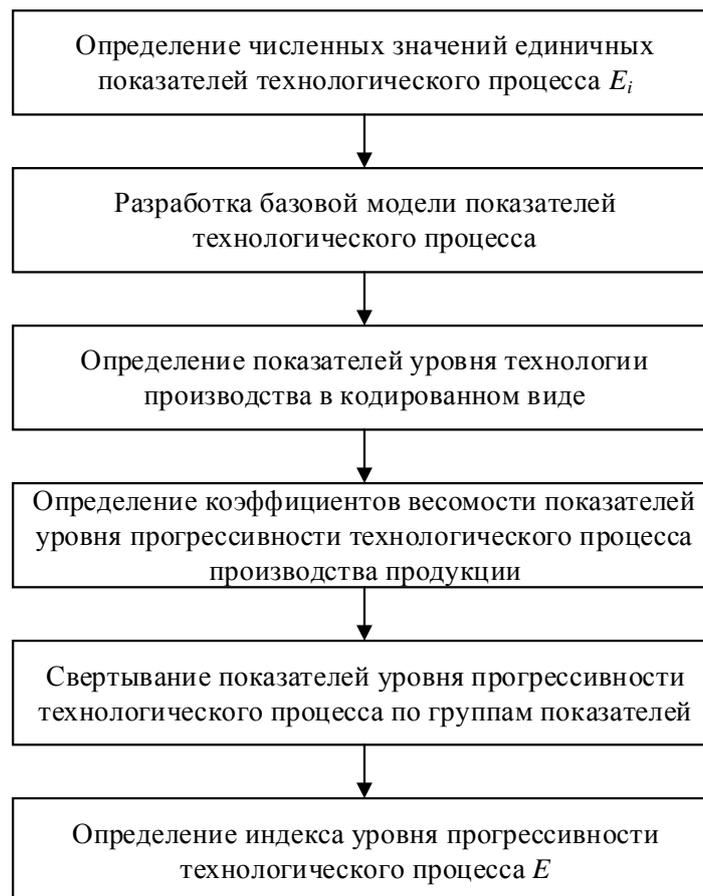
Рисунок 2.3 – Блок-схема для определения индекса уровня прогрессивности технологического процесса
