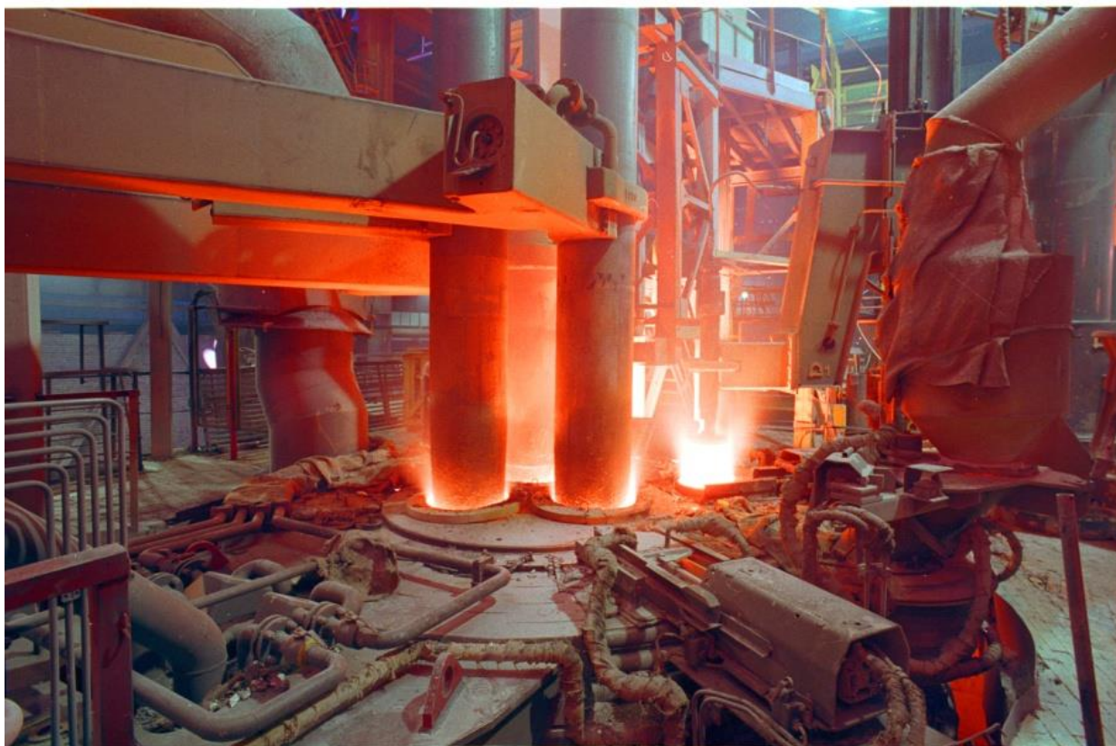
Рисунок 3.8 – Электродный портал двухпозиционного агрегата «ковш-печь» в рабочем положении
