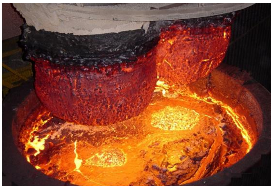
Рисунок 3.11 – Вид патрубков УВС №2 после окончания обработки металла
