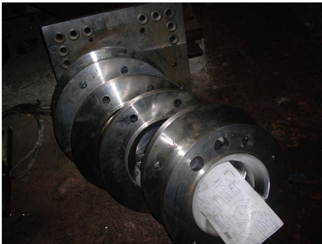
Опытная партия фланцев из патентованной марки стали для фурм доменной печи (ООО «Литейно-мателлургические технологии»)
