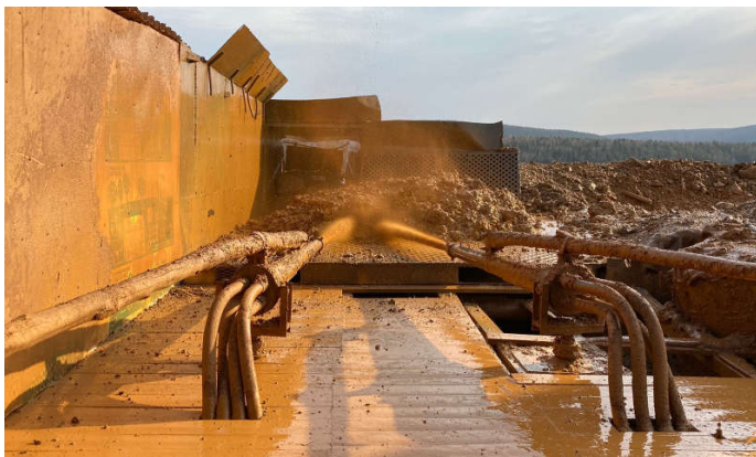
Рисунок 1 – Размыв пород гидромонитором со значительным содержанием тонкодисперсных грунтовых частиц при оборотном водоснабжении
