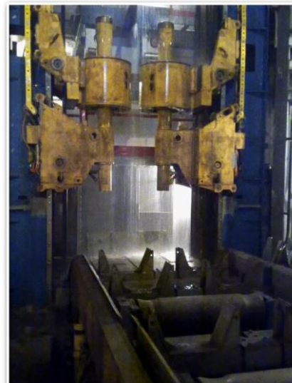
Рисунок 4.36 – Каретки ЭМП в зоне окончания затвердевания: слева – перед установкой на МПНЛЗ, справа – на МПНЛЗ с установленными статорами
