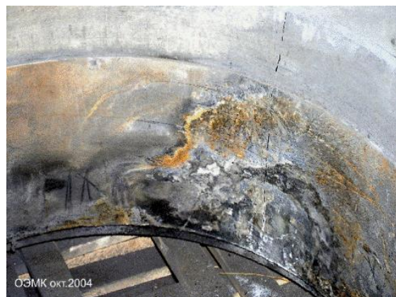
Рисунок 1.5 – Устройство ЭМП наружного исполнения, вышедшее из строя на МНЛЗ-1 АО «ОЭМК»
