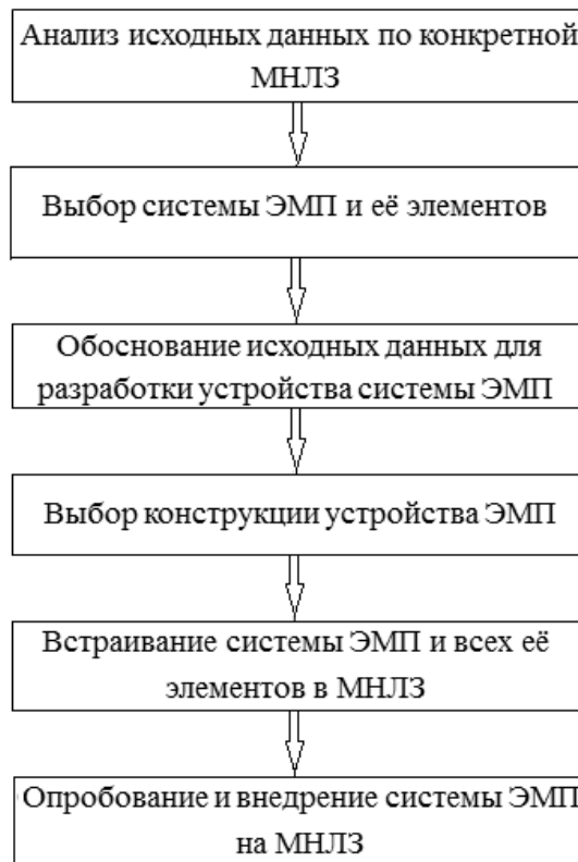
Рисунок 5.26 – Общая схема методологии разработки и опробования систем электромагнитного перемешивания на МНЛЗ
