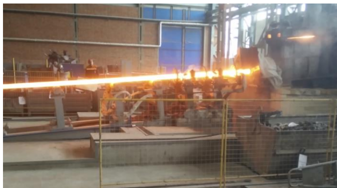
Рисунок 5.11 – Разливка заготовок диаметром 80 мм из легированных марок стали с ЭМП в кристаллизаторе горизонтальной МНЛЗ
