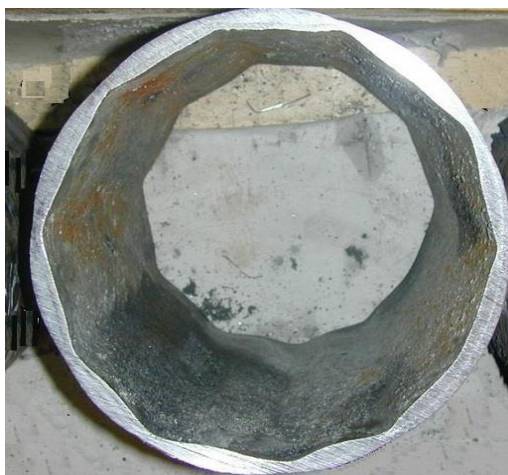
Рисунок 4.40 – «Чулок» в зоне прорыва круглой заготовки [369].
