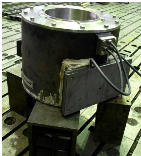
Рисунок 4.35 – Статор ЭМП-3 для литья заготовок диаметром 250 и 360 мм
