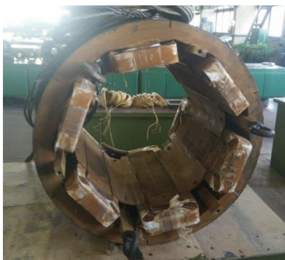
Рисунок 1.6 – Статор ЭМП наружного исполнения, вышедший из строя на МНЛЗ-3 ПАО «Ижсталь»
