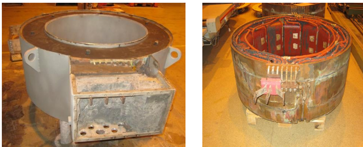
Рисунок 1.7 – Устройство ЭМП наружного исполнения, вышедшее из строя на МНЛЗ-2 ПАО «Тагмет»: слева – со срезанной верхней частью корпуса; справа – статор без корпуса
