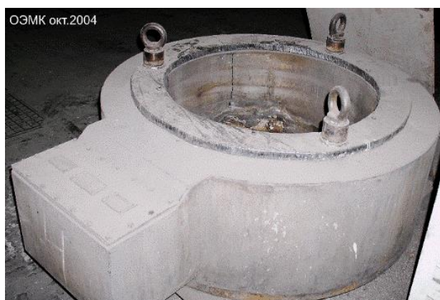
Рисунок 1.5 – Устройство ЭМП наружного исполнения, вышедшее из строя на МНЛЗ-1 АО «ОЭМК»
