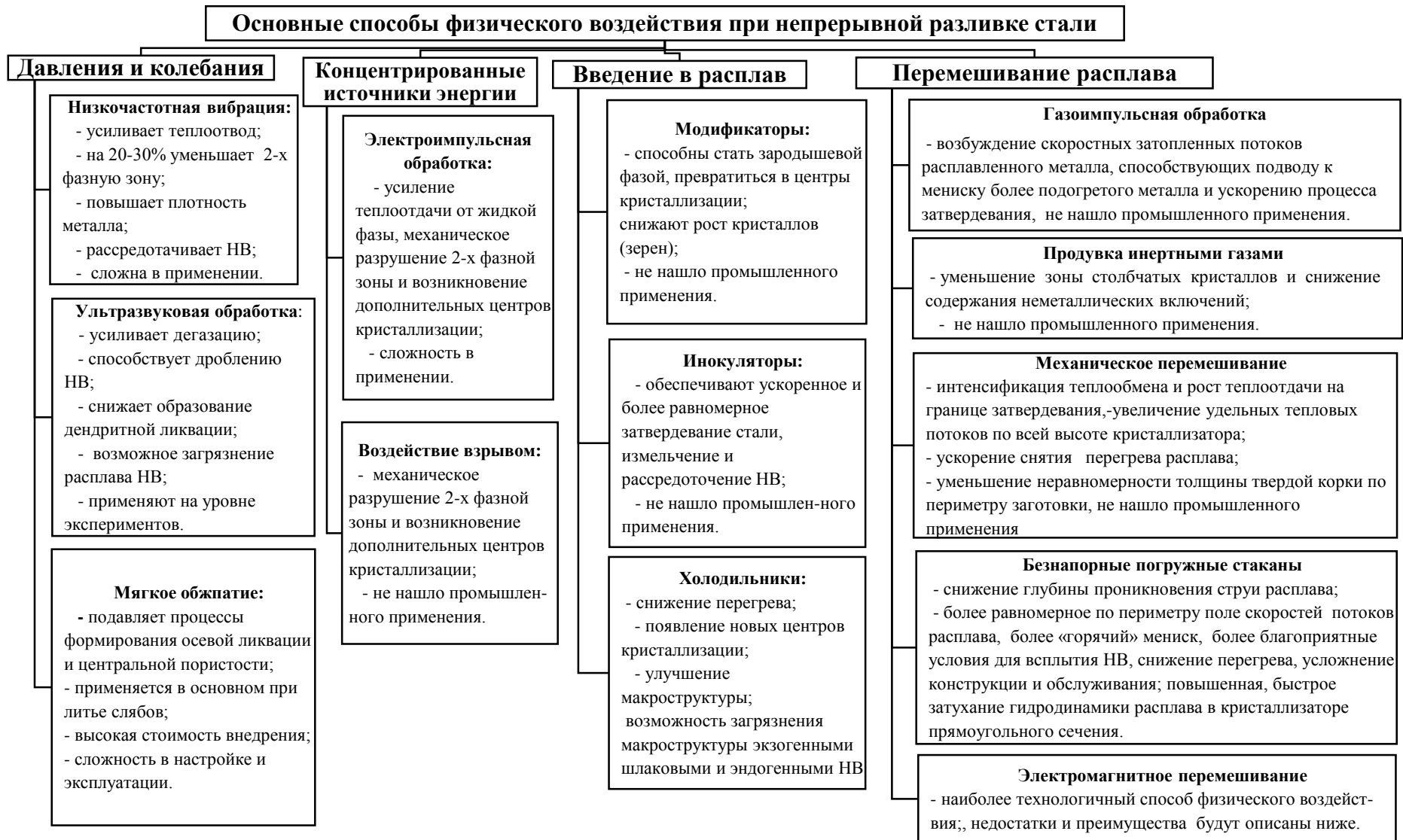
Рисунок 1.2 - Анализ основных способов внешнего физического воздействия при непрерывной разливке стали на кристаллизующую заготовку
