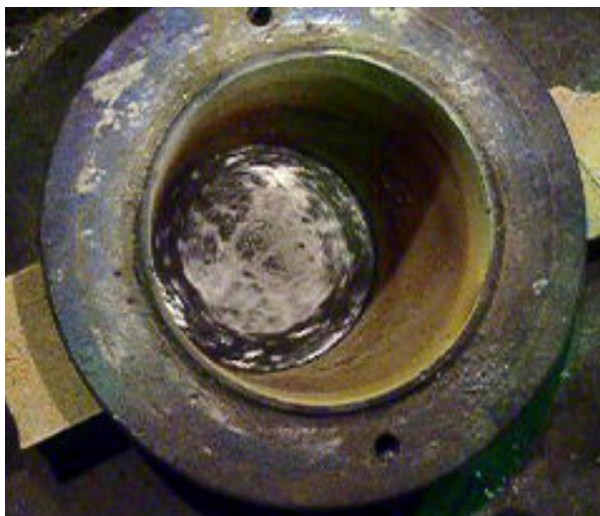
Рисунок 3.9 – Вид сверху на стенд для физического моделирования МГД-процессов при ЭМП в кристаллизаторе
