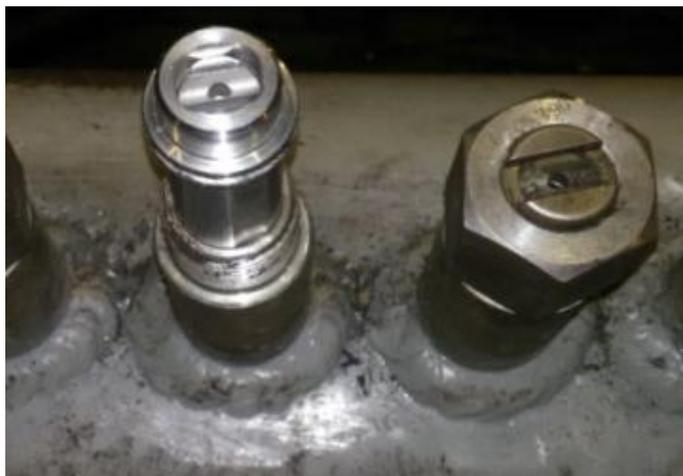
**Рисунок 5.26** - Форсунки системы водовоздушной завесы, внедренные в условиях действующего производства
