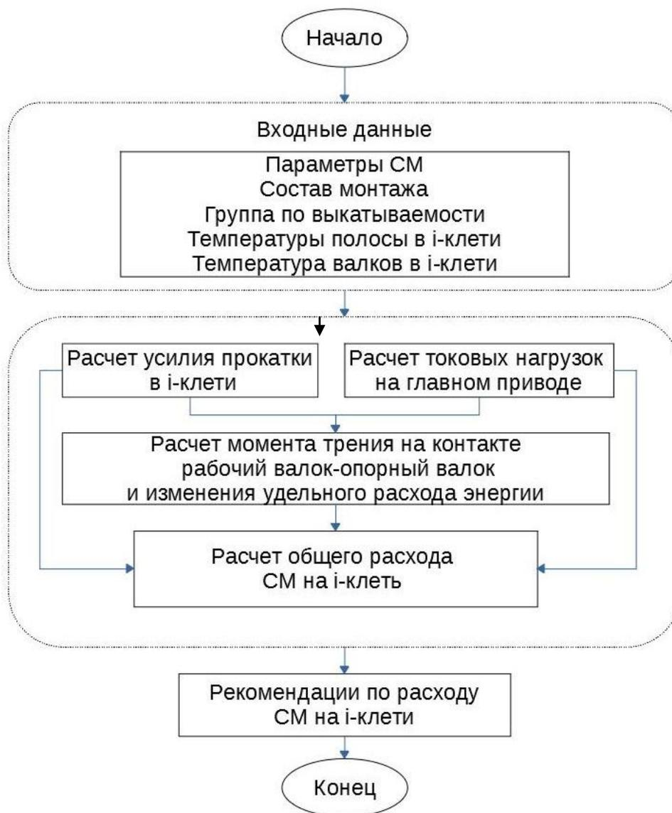
**Рисунок 5.10** - Алгоритм определения расходов СМ в технологии листовой горячей прокатки
