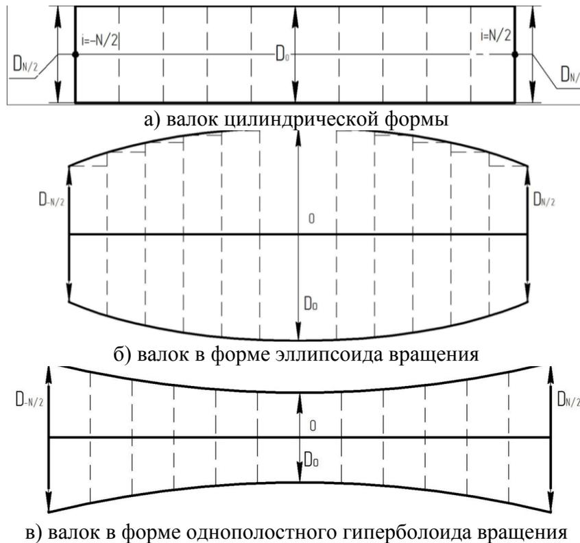
**Рисунок 3.13 - Формы валков прокатных станов**
