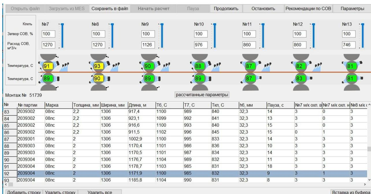
**Рисунок 5.2** - Главное окно разработанного программного обеспечения (ПО) «Расчет теплового состояния рабочих валков»
