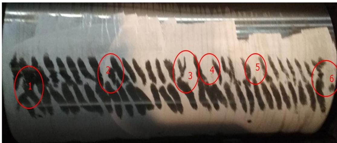
**Рисунок 5.16** - Следы воздействия форсунок охлаждения для нижнего рабочего валка.
