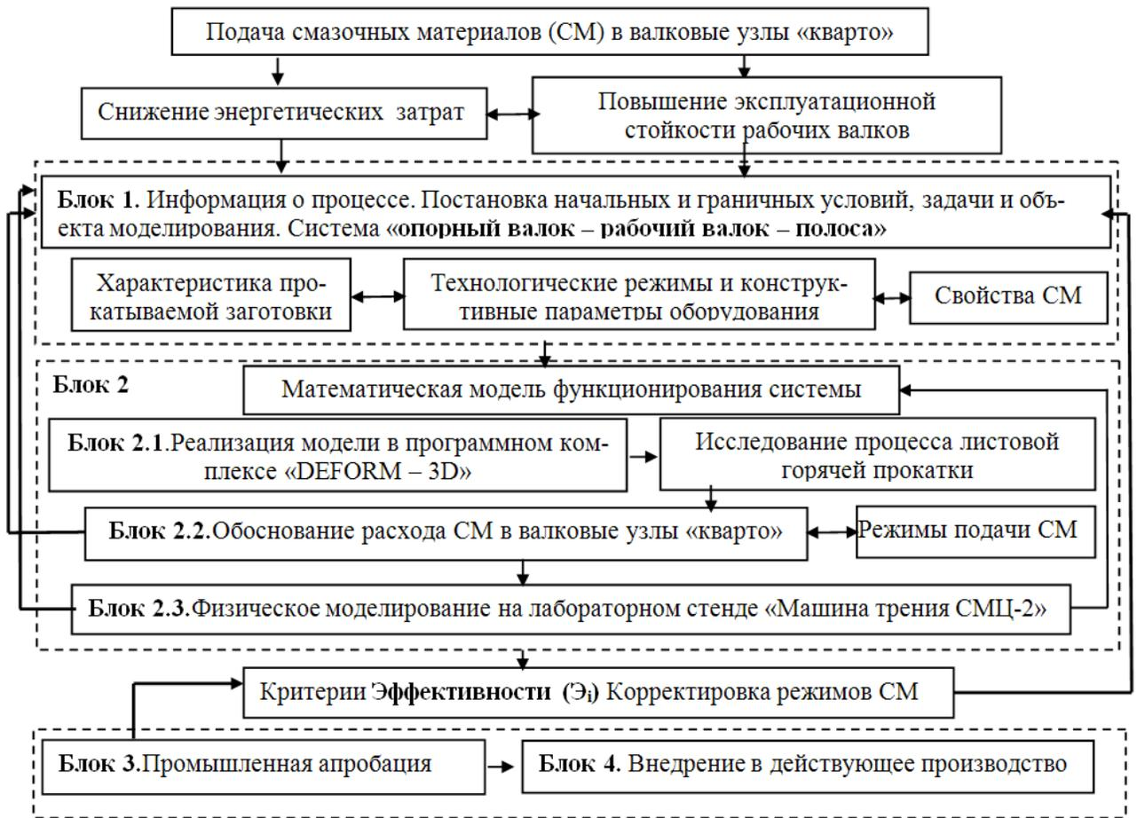
**Рисунок 3.19** - Методология исследования системы «опорный валок – рабочий валок – полоса» при применении технологии подачи СМ в четырехвалковых клетях «кварто»
