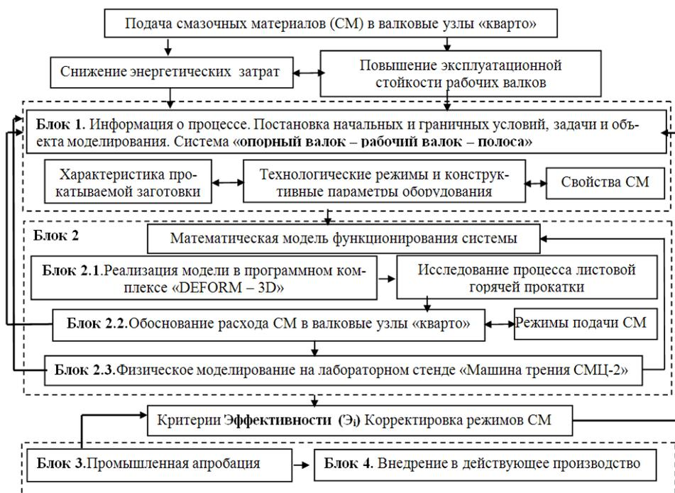
**Рисунок 5.** Методология исследования системы «опорный валок – рабочий валок – полоса» при применении технологии подачи СМ в четырехвалковых клетях «кварто»
