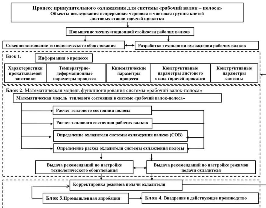
**Рисунок 10.** Методология исследования системы «рабочий валок – полоса» для технологии принудительного охлаждения рабочих валков и полосы
