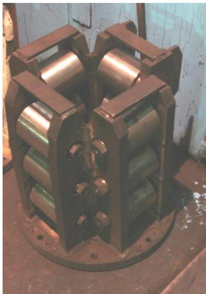
Рисунок 4.3 – Трехсекционный роликовый блок подвески ЗВО сортовой МНЛЗ
