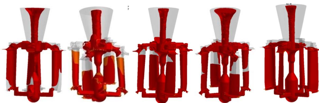
Рисунок 4.27 – Слияние потоков в блоках с диаметрами дросселя 11, 12, 14, 15,5 и 18 мм соответственно
