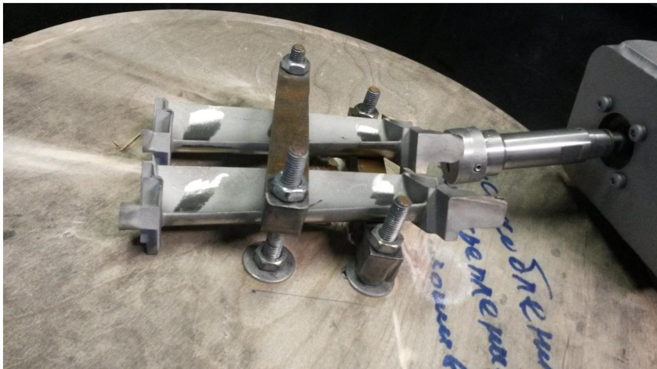
Рисунок 5.11 – Гидродинамическая установка для удаления стержней
