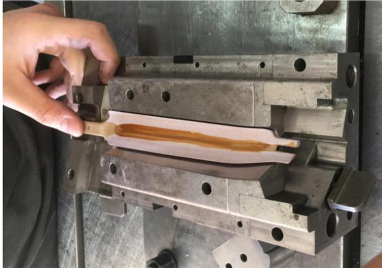
Рисунок 5.8 – Установка стержня в пресс-форму
