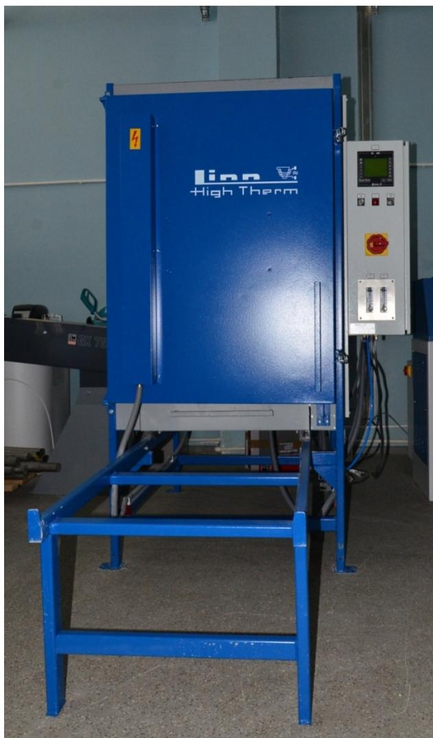
Рисунок 4.4 – Внешний вид камерной электрической печи Linn KK500
