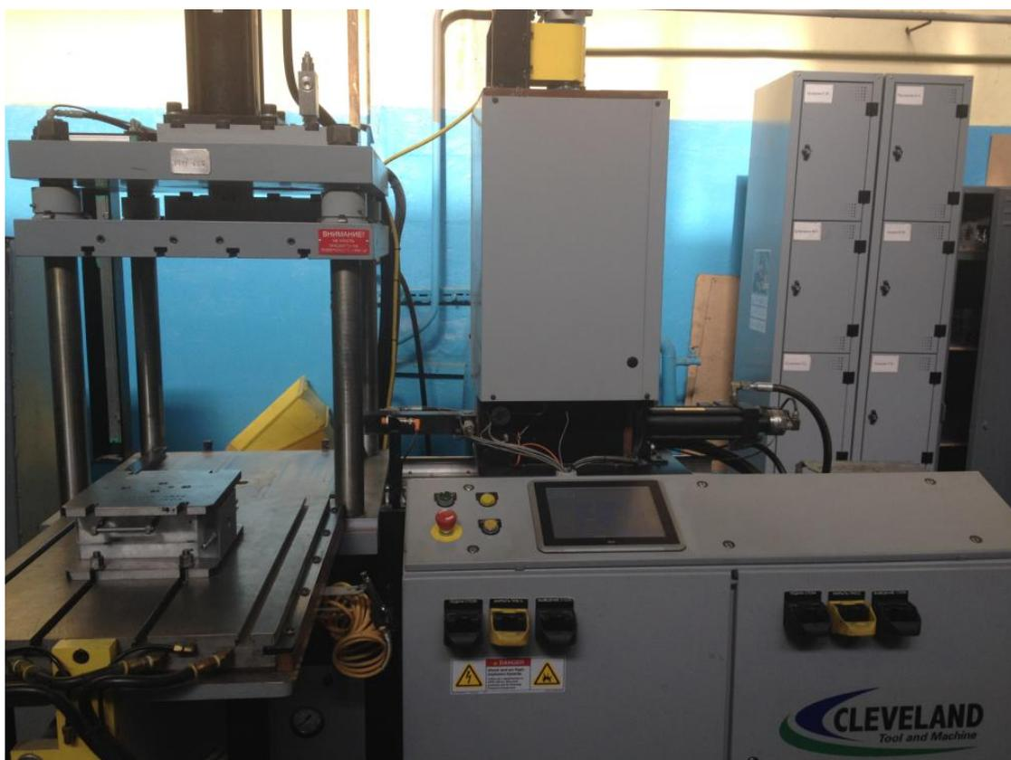
Рисунок 5.1 – Внешний вид пресс-автомата с пресс-формой на столе
