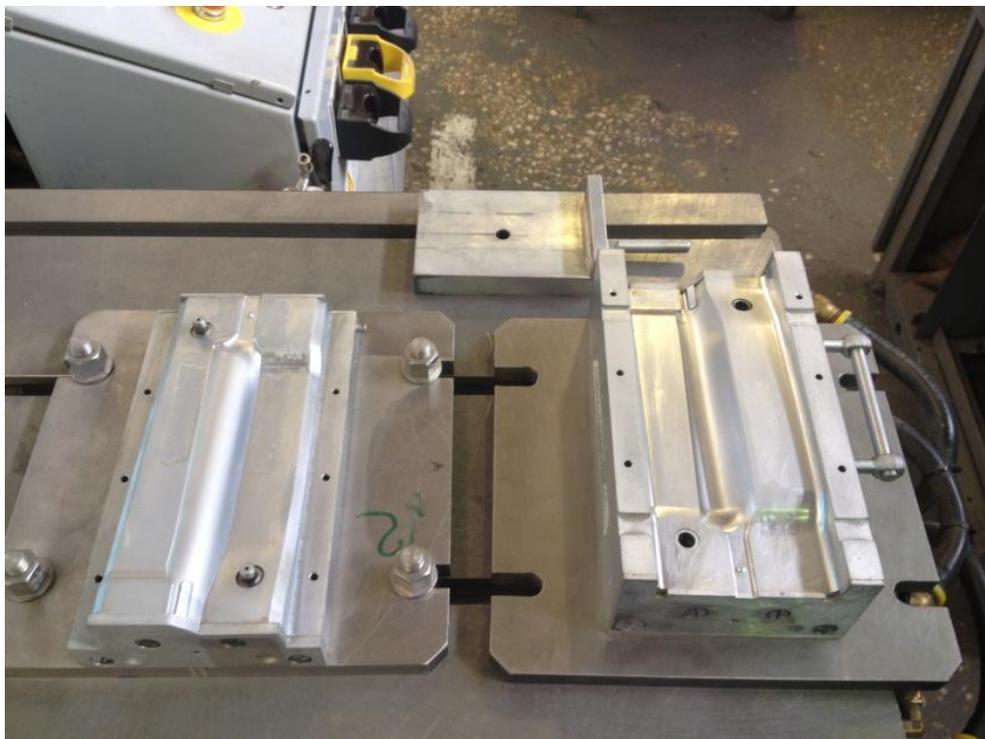
Рисунок 5.2 – Внешний вид разобранной пресс-формы стержня (нижняя половина пресс-формы стационарно закреплена на столе пресса)
