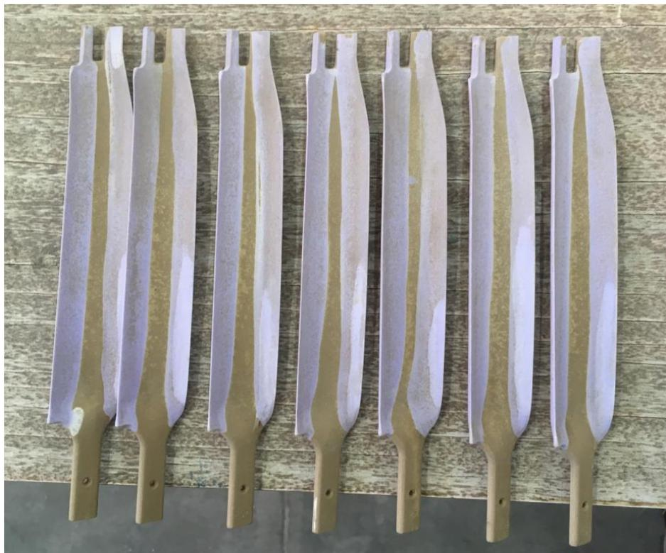
Рисунок 5.6 – Внешний вид пропитанных стержней
