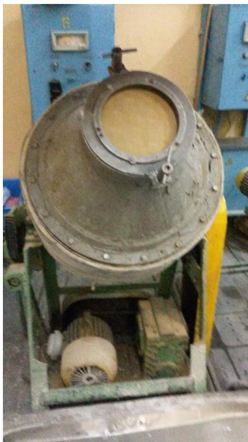
Рисунок 4.1 – Конвертор для приготовления пластификатора
