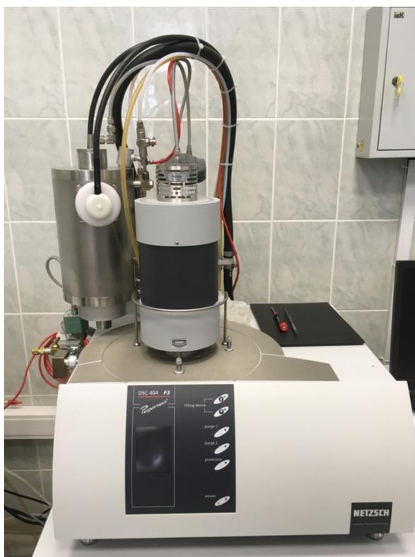
Рисунок 2.19 – Внешний вид дифференциального калориметра
