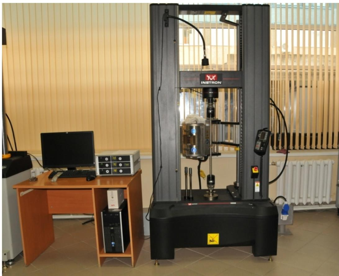
Рисунок 2.13 – Внешний вид установки для исследования термомеханических свойств
