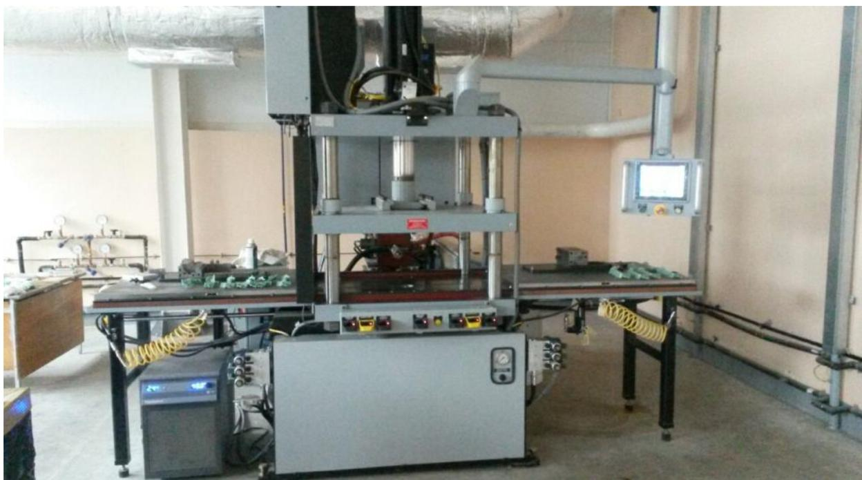
Рисунок 5.7 – Внешний вид пресс-автомата СТМ-50
