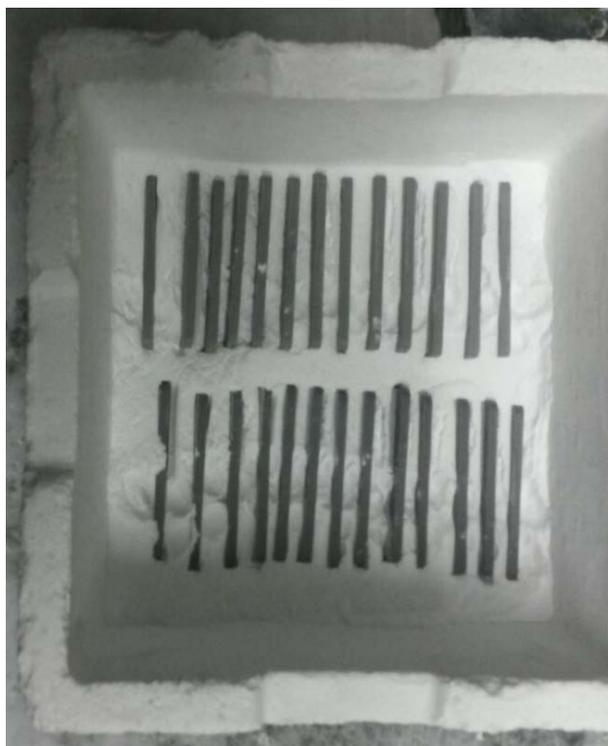
Рисунок 4.3 – Образцы, уложенные в короб, перед обжигом
