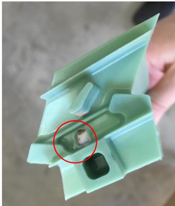
Рисунок 5.9 – Изображение модели лопатки со сломом хвостовика стержня
