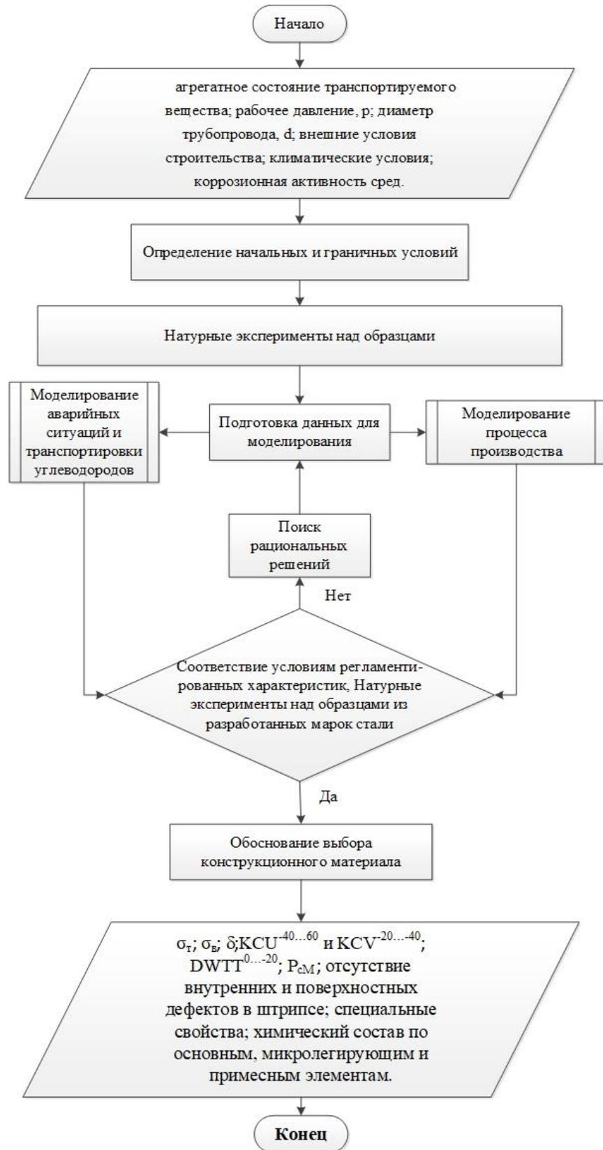
Рисунок 52 – Алгоритм поиска решения разработки технологии производства высокопрочного толстолистового проката для трубопроводов, работающих в условиях повышенной сейсмичности
