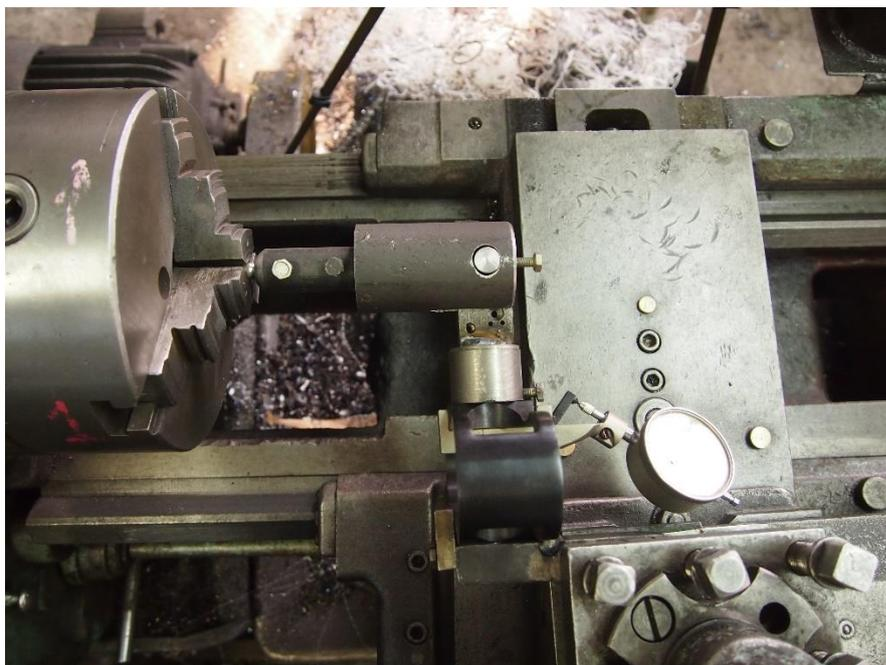
*Рисунок 34 – Установка образца перед началом опыта на поперечный изгиб при вращении на базе токарно-винторезного станка 1А616*
