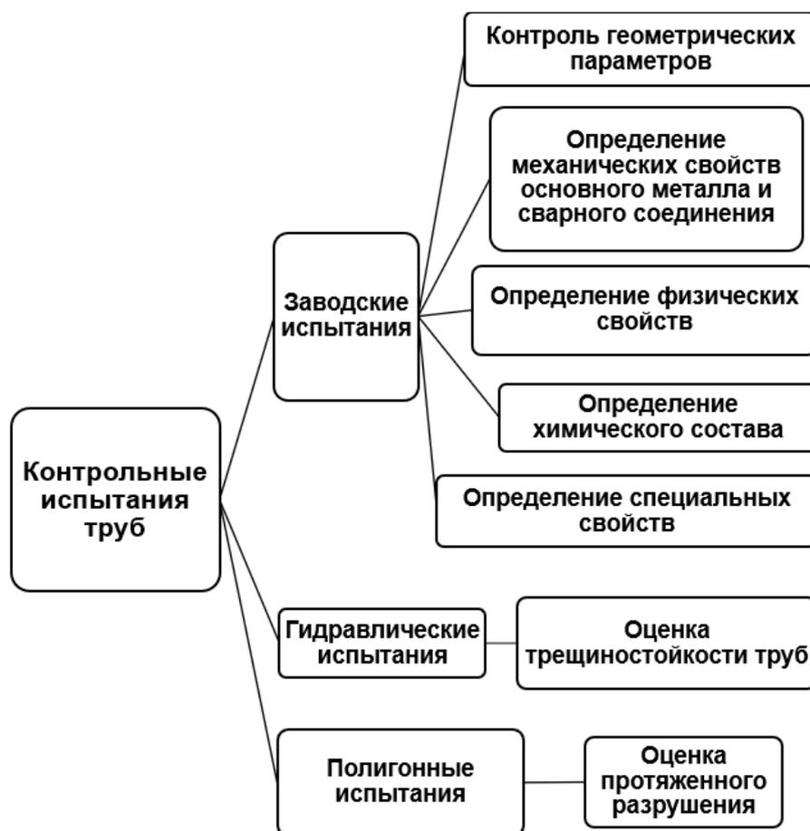
Рисунок 5 – Контрольные испытания труб и материала
