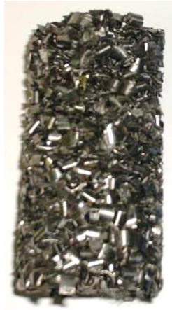
Рисунок 1.9 – Брикет из стружки нержавеющей (высоколегированной) стали. Размер: 53x100 мм; плотность 1500 кг/м 3 (пористость 80%); масса 0,340 кг
