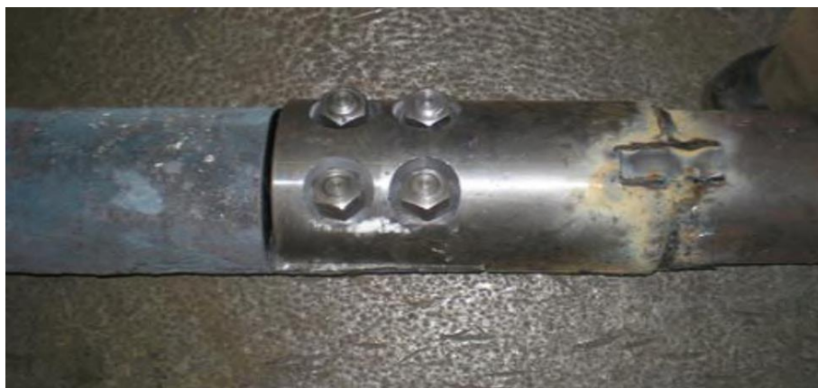
Рисунок 3.11 – Собранный электрод ЭШП из ножевой стали: а – фрезеровка площадки под переходник к инвентарной головке, б – сверловка четырех отверстий под болты, в – стяжка на болты и приваривание инвентарной головки
