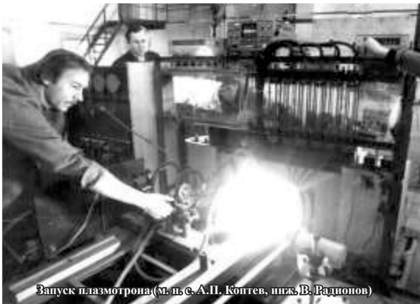
Запуск плазматрона (м. п. с. А.П. Коптев, инж. В. Радионов)
