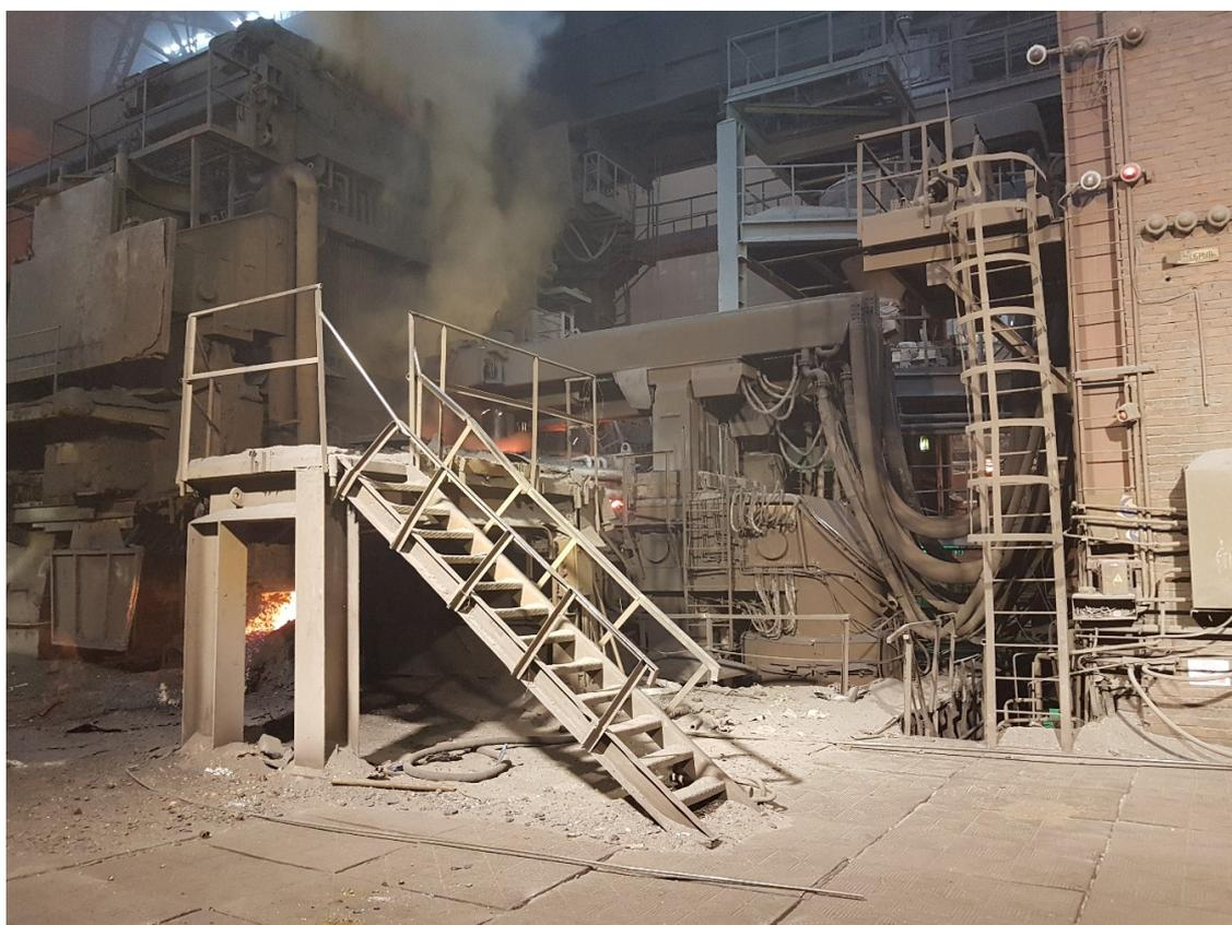
Рисунок 2.1 - Общий вид дуговой сталеплавильной печи шахтного типа ШП-125
