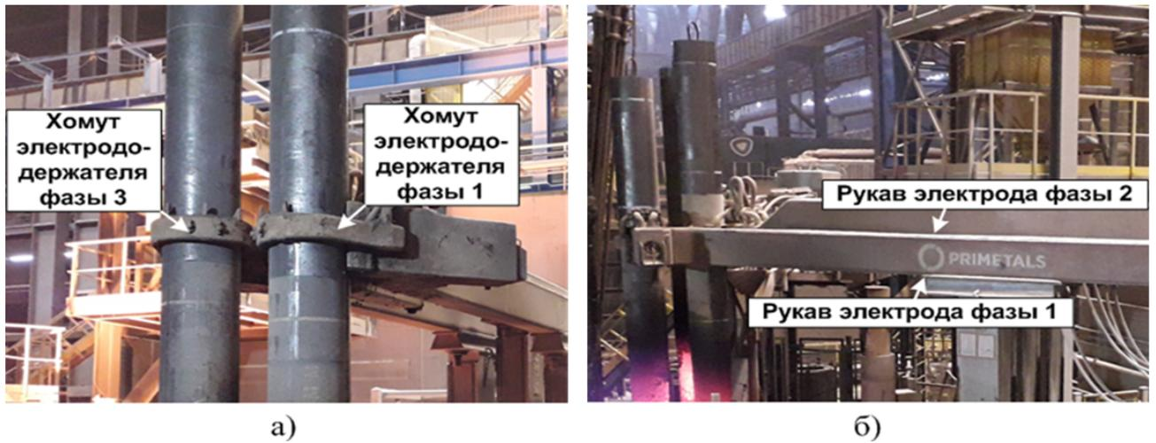
Рисунок 2.4 - Корректное взаимное расположение хомутов (а) и рукавов электродов (б) при проведении опытов КЗ
