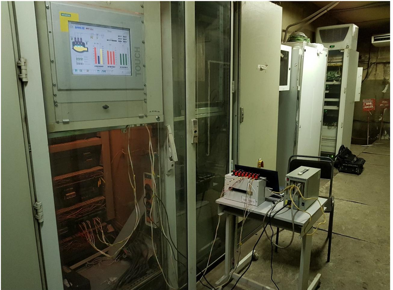
Рисунок 3.10 - Экспериментальная площадка для получения осциллограмм мгновенных значений тока электрической дуги и фазного напряжения ШП-125
