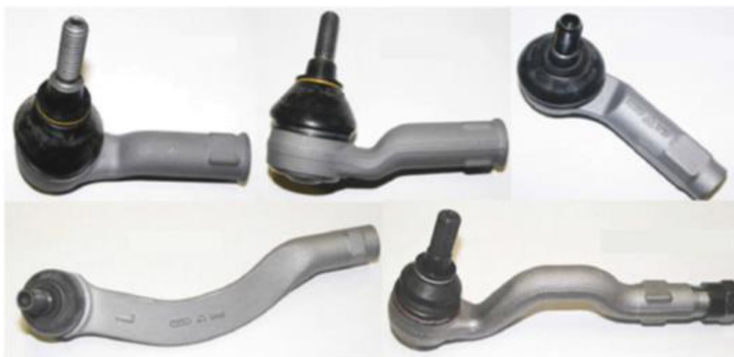
Рисунок 1.6 – Различные варианты конструктивного исполнения корпуса наружного рулевого наконечника:
