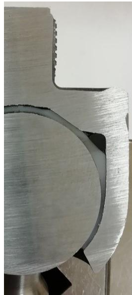
Рисунок 4.10 – Вид осевого сечения образца после опрессовки
