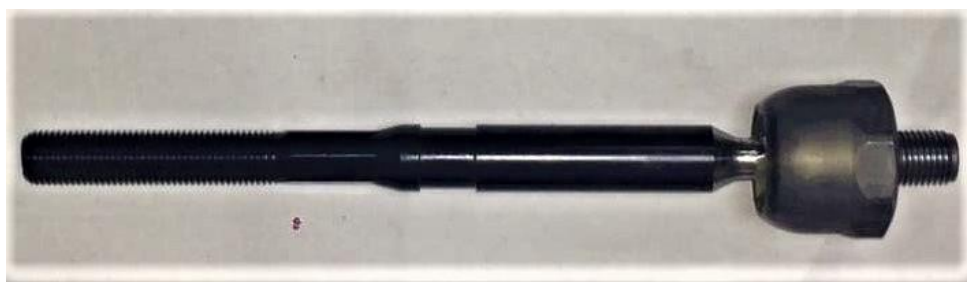
Рисунок 4.21 – Внутренние рулевые наконечники
