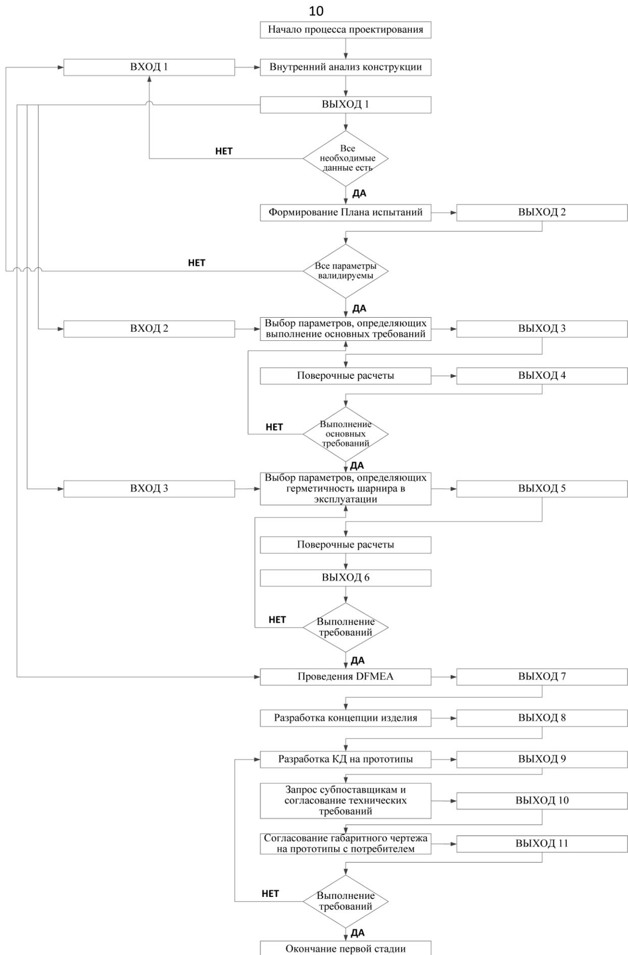
Рисунок 2 – Алгоритм процесса проектирования на Стадии 1: Разработка концепции изделия и создание прототипов наружных и внутренних рулевых наконечников автомобиля
