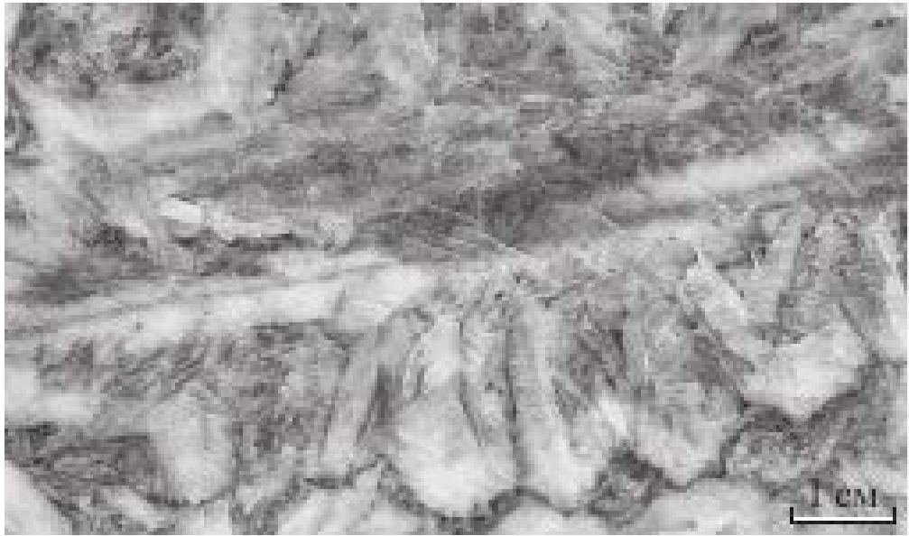
Рисунок 6 – Микрофотография Саткинского магнезита
