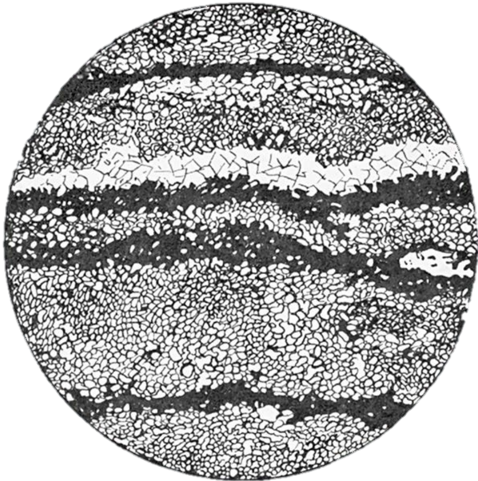
Рисунок 7 – Микрофотография Саткинского магнезита, Анализатор – Николи +, увеличение – 64
