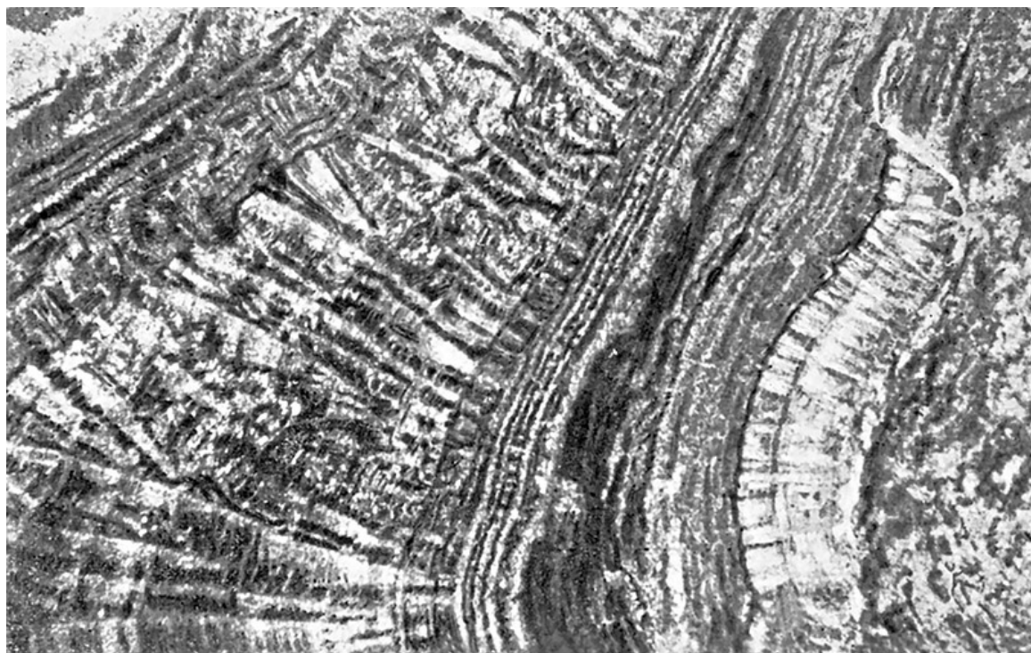
Рисунок 5 – Фотография шлифа магнезита Саткинского месторождения.
