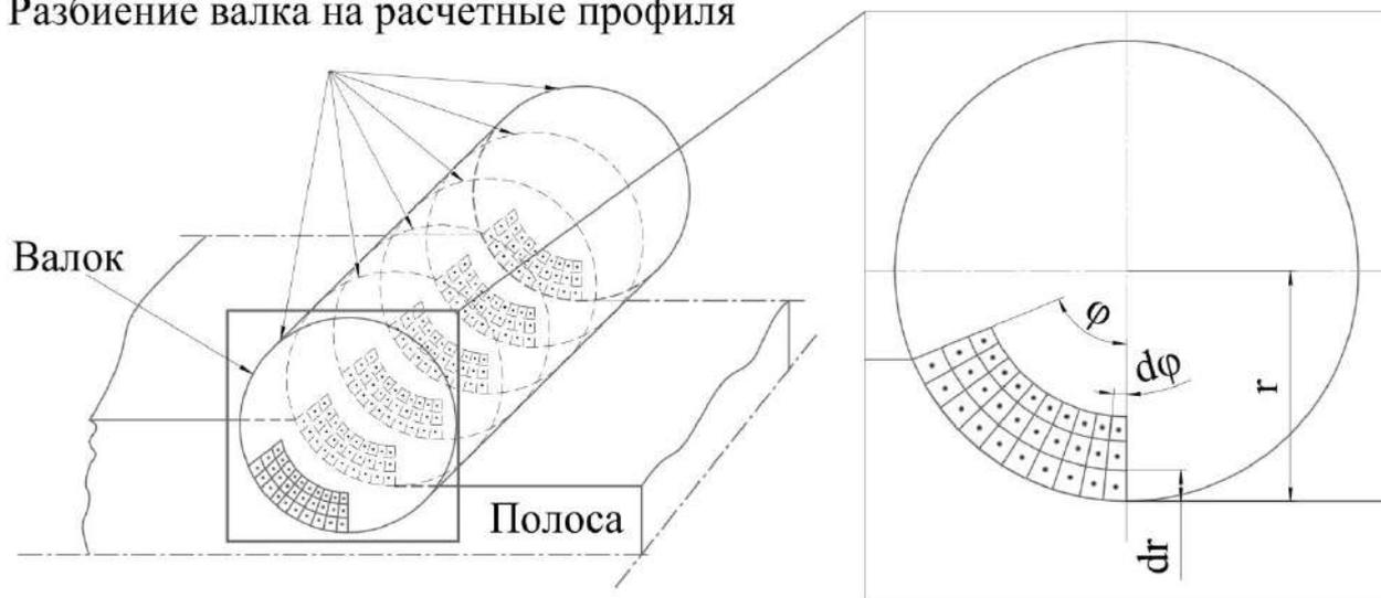
Рисунок 3.7 – Разбиение бочки валка для расчета его теплового состояния
